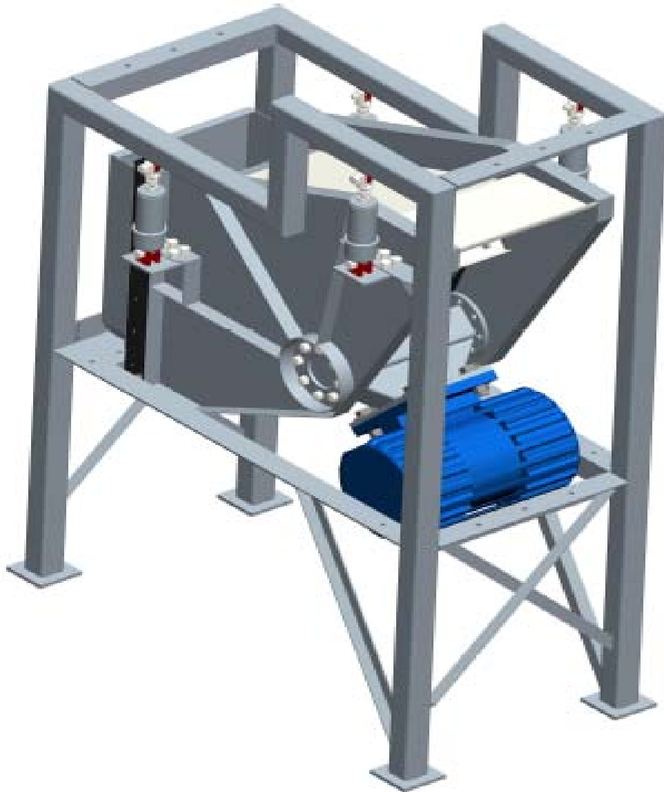
Figura N° 43: Vista en 3D de tamizadora de harina de yuca final
