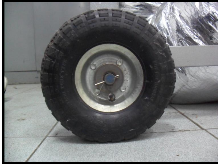
Figura 2.13 “Rueda neumática de la cámara de secado”.
