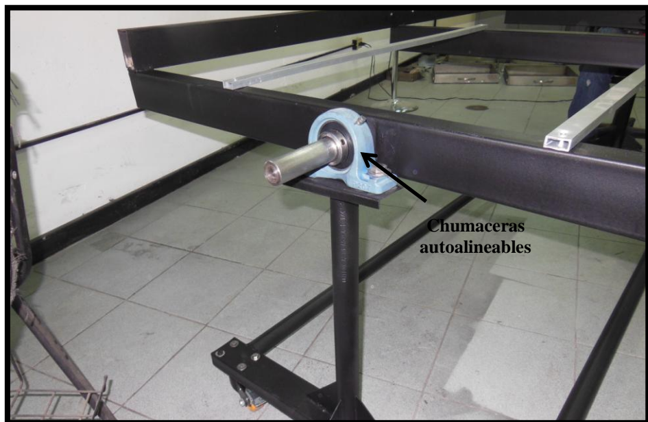
Figura 4.3 Sistema de rotación de la estructura soporte
