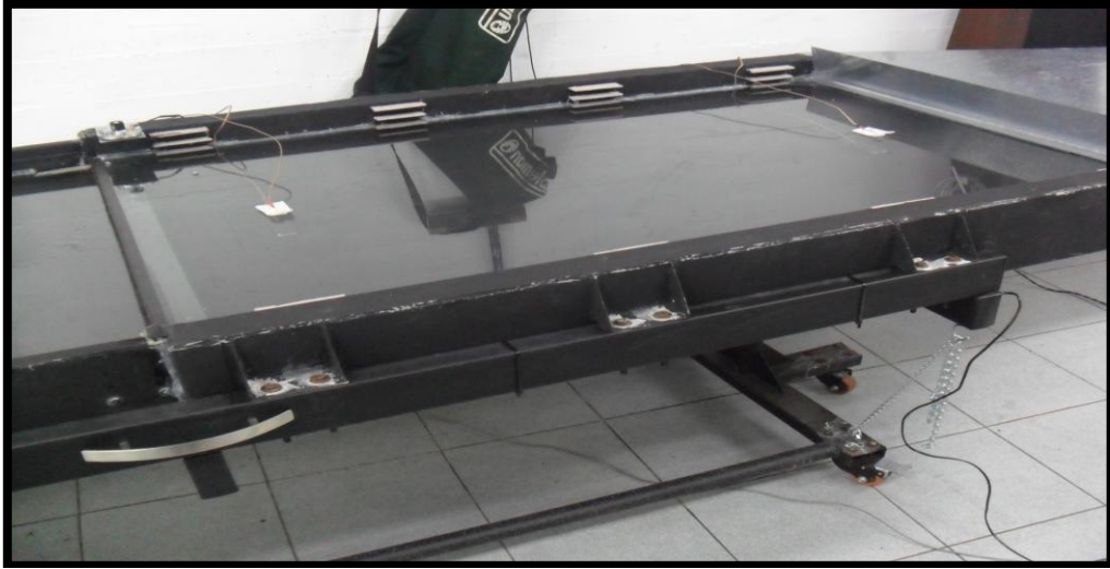
Figura 3.10 “Placa cubierta colocada sobre el módulo fijo”
