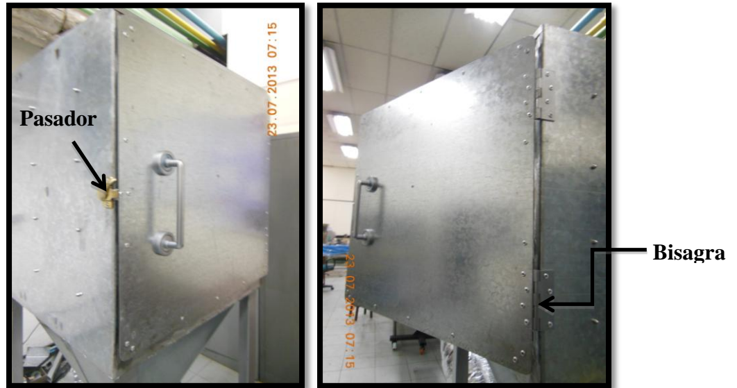
Figura 2.7 “Bisagra y pasador de la cámara de secado”
