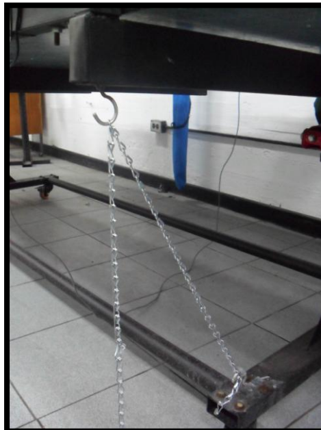
Figura 4.9 “Sistema de cadena para frenar el movimiento de rotación del colector solar”
