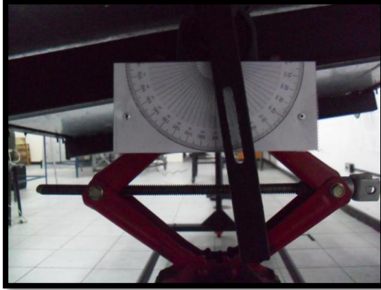
Figura 4.10 “Referencia para rotar el colector solar”
