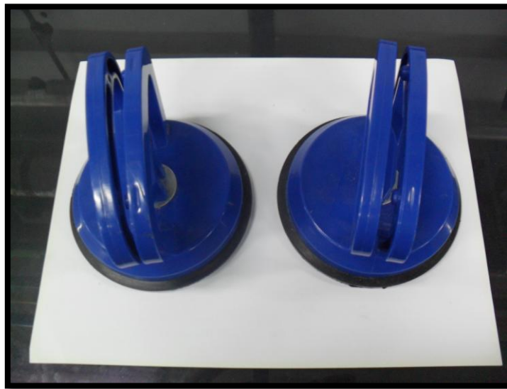
Figura 8.1 “Ventosas para trasladar las placas cubiertas”
