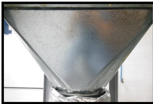
Figura 2.6 “Difusor de entrada de la cámara de secado”
