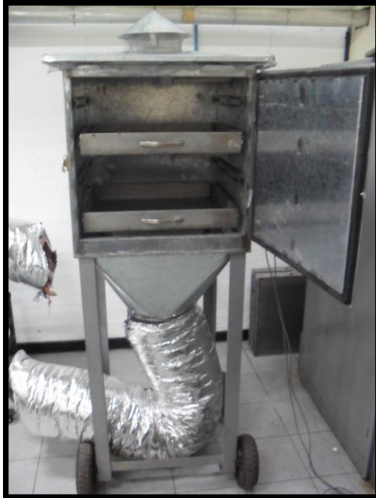
Figura 2.16 “Ensamblaje final de la cámara de secado puerta abierta”
