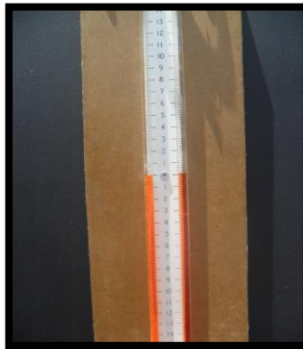
Figura 5.8 “Manómetro diferencial tipo U de la cámara de secado”
