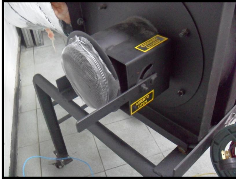
Figura 8.2 “Damper o regulador de flujo de aire del ventilador centrífugo”.
