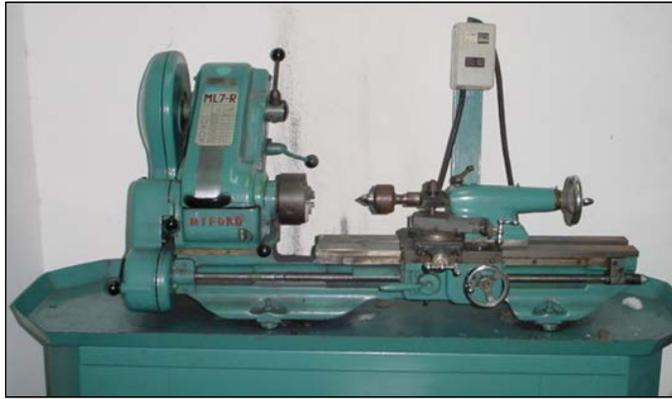
**Figura 3-5.** Fotografía del torno Myford, modelo ML7-R, donde se pulieron las probetas para el ensayo de fatiga
