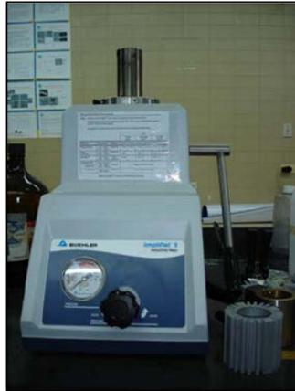
**Figura 3-17.** Equipo para embutido de probetas
