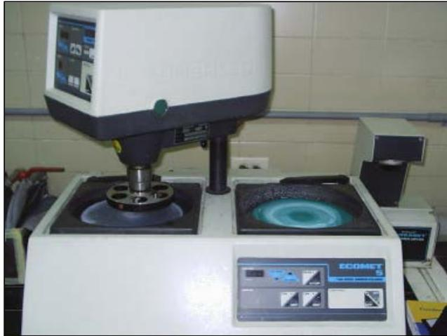
**Figura 3-6.** Máquina para pulido de plato giratorio
