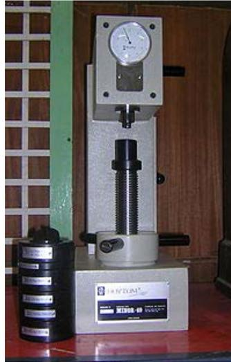
**Figura 2-12.** Durómetro.
