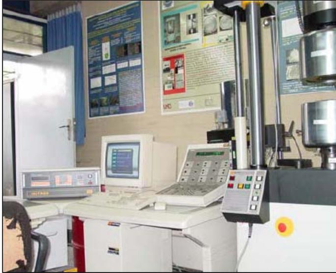
**Figura 3-8.**Máquina para ensayo de tracción
