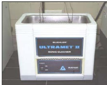
**Figura 3-14.**Equipo de limpieza por ultrasonido.
