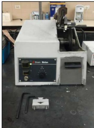
**Figura 3-15.** Máquina de corte de disco de diamante Struers Minitorm.
