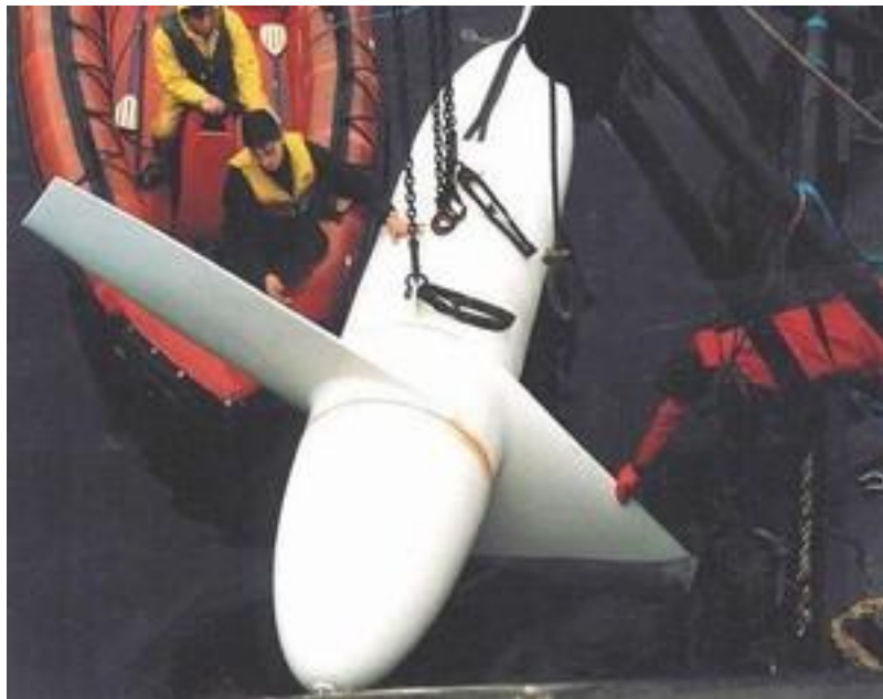
Figura 1-6: Primera Turbina de corriente de marea fabricada por la empresa IT Power (Fraenkel, 2010)
