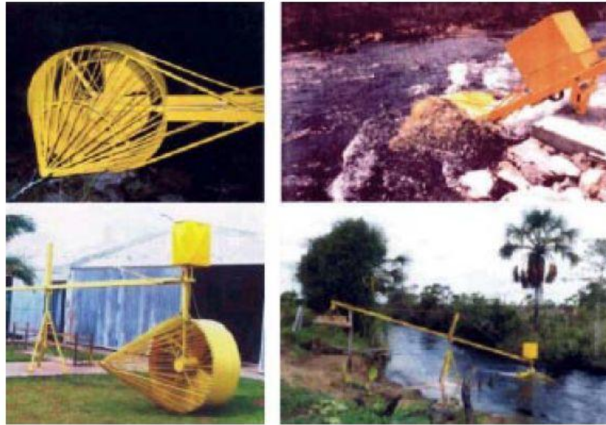
Figura 1-13: Modelos instalados de turbinas desarrolladas por la UNB para los experimentos de campo (Tiago F, 2003)
