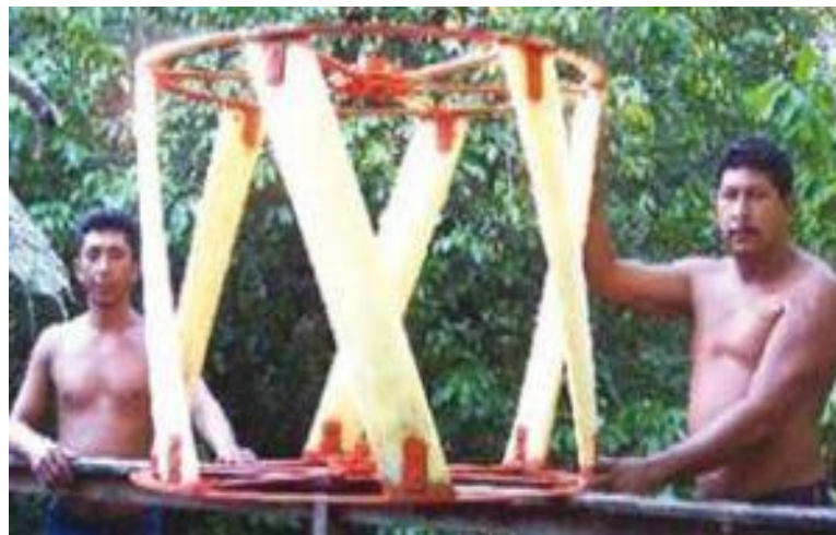
Figura 1-14: Turbina tipo Gorlov utilizada en el río Amazonas en Brasil (Anderson S. , 2009)
