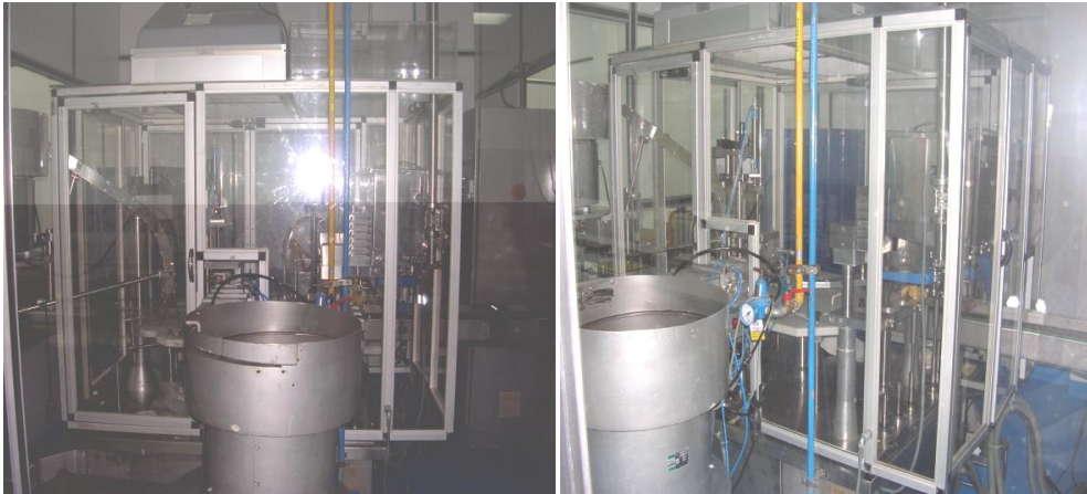
Fotos 3.6: Llenadora-Tapadora (HISPAMEC). Fuente: El investigador (2010).
