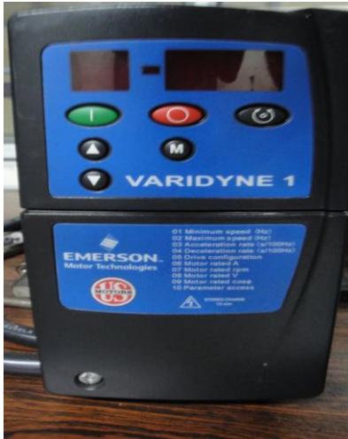
Figura 1.14 Variadores de Frecuencia
