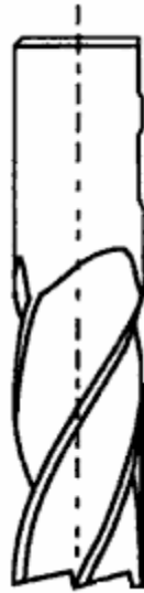
Figura 16: Geometría de una Herramienta Típica Helicoidal para Fresadora (Fuente: “Manufacturing Automation”. Yusuf Altintas. Pag 40. 2006)
