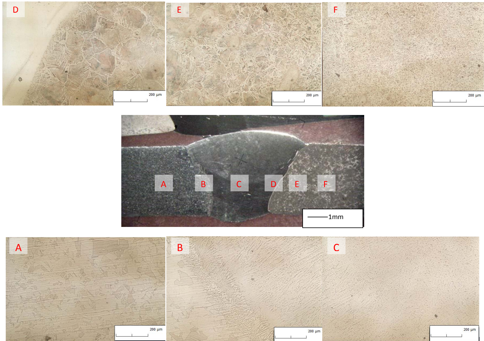
Fig. 3.14. Macrografía y micrografías de la junta soldada por GTAW.
