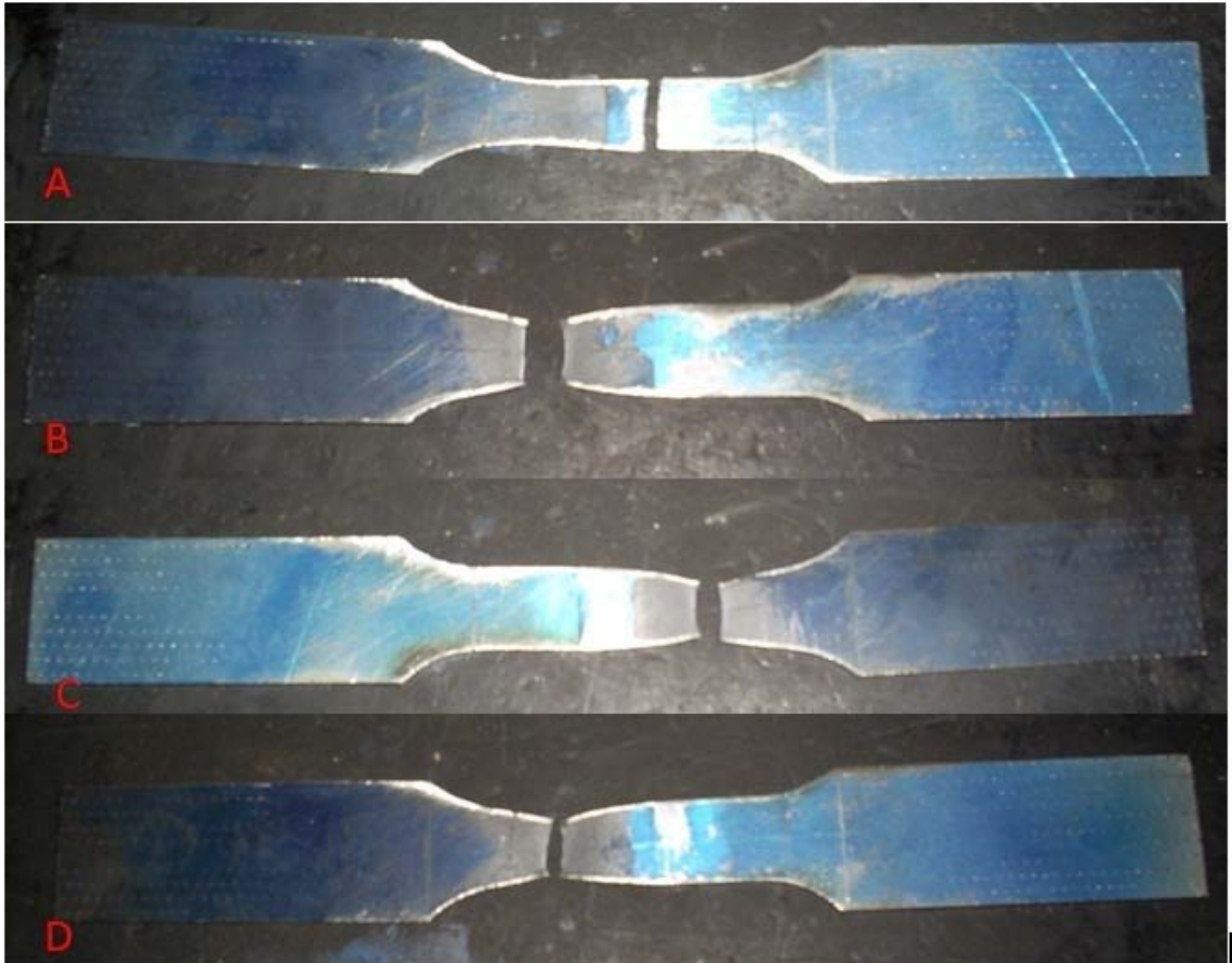
Fig. 3.33 probetas de tracción ensayadas: A SMAW 1, B SMAW 2, C GTAW 1, D GTAW 2
