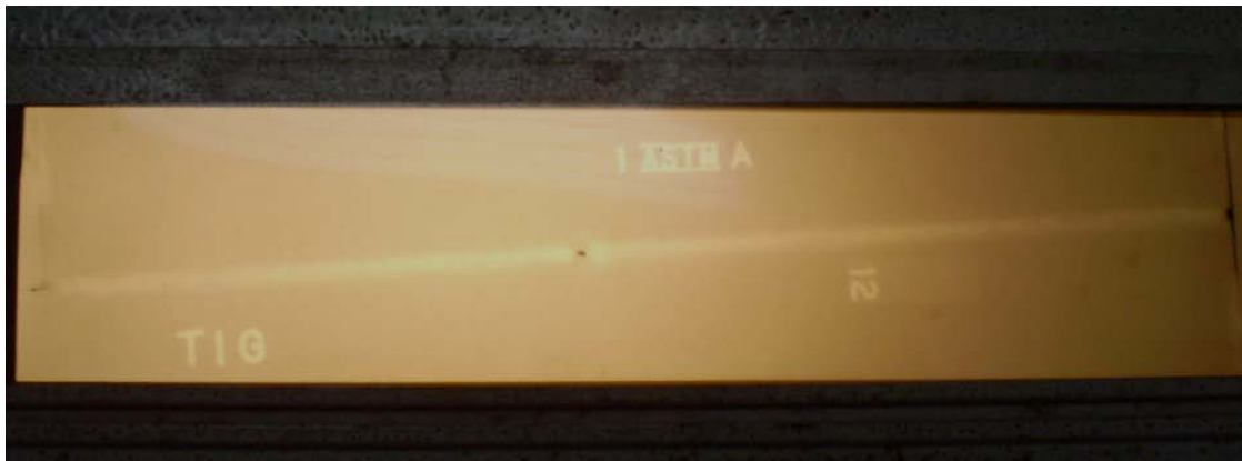
Fig. 3.13 Radiografía correspondiente al cordón de soldadura GTAW
