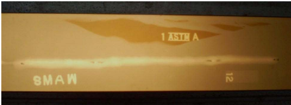
Fig. 3.12 Radiografía correspondiente al cordón de soldadura SMAW
