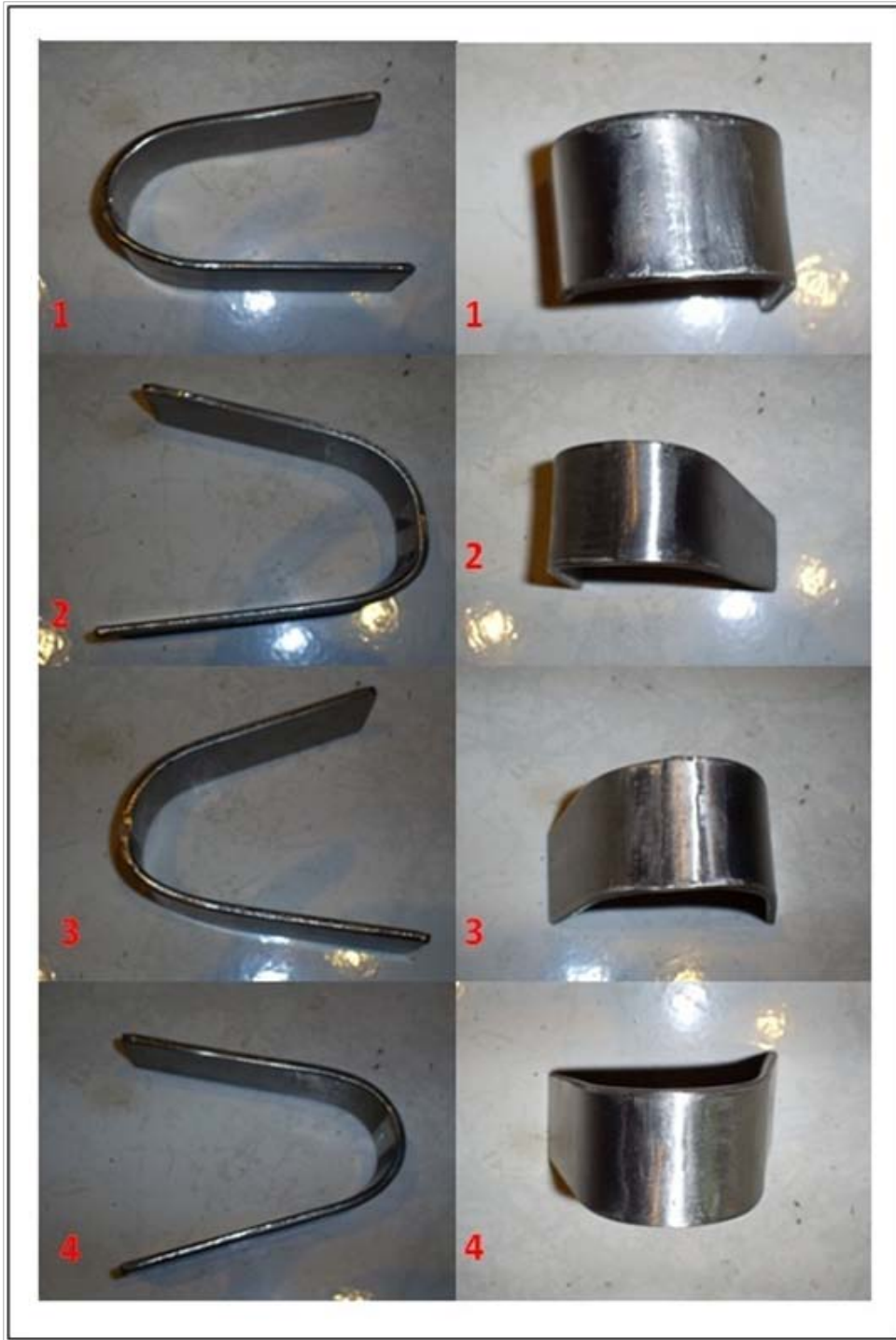
Fig. 3.28. Ensayo de doblado: (1) Doble de raíz soldadura GTAW, (2) Doble de cara GTAW, (3) Doble de cara SMAW, (4) Doble de raíz SMAW.
