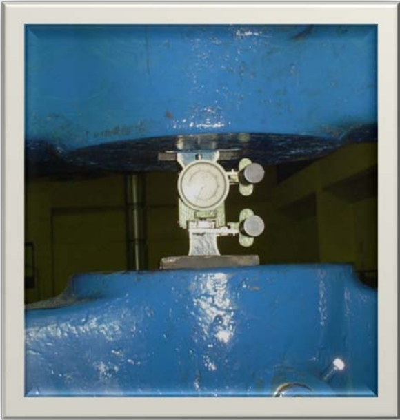
Fig. 2.9 Extensómetro aplicado a la probeta
