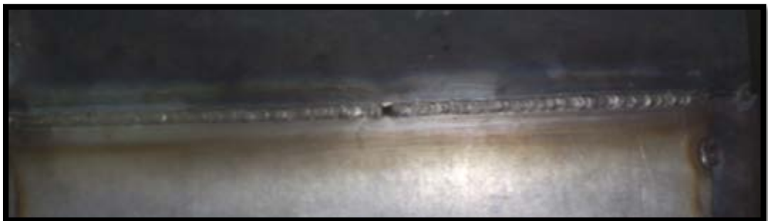
Fig. 3.10. Cordón de soldadura depositado con el proceso GTAW.
