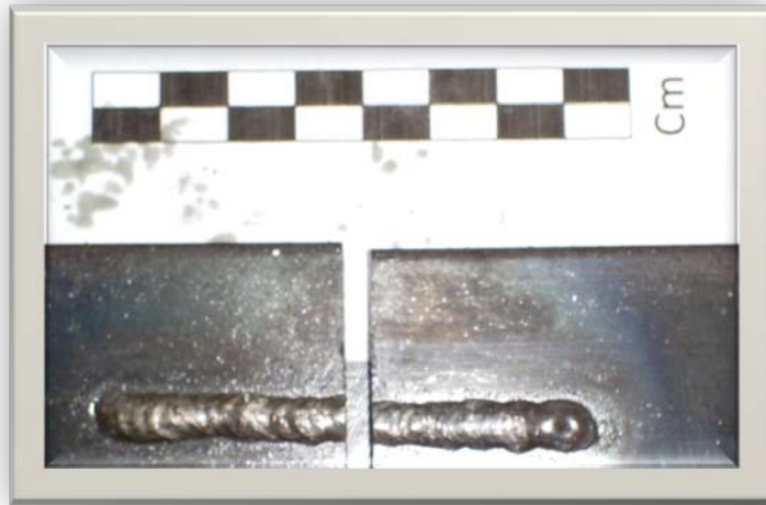
Fig. 2.14. Corte de una de las muestras de soldadura por GTAW.
