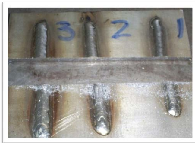
Fig. 2.13. Corte de las muestras de soldadura de electrodo revestido.
