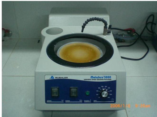
**Figura 2. 3.** Equipo de pulido Mecánico Marca Buehler.
