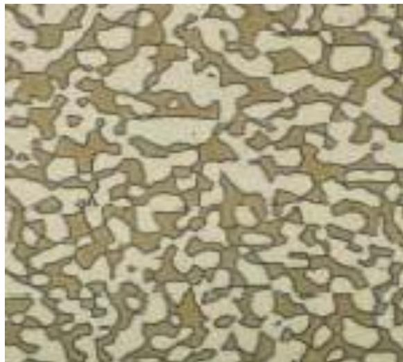
**Figura 1. 2.** Microestructura de la aleación 2507, laminada en frío y templada. Ferrita (Fase Oscura) y Austenita (Fase Clara)
