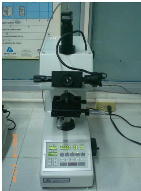
**Figura 2. 6.** Microdurometro Vickers Marca Buehler, Modelo 1105
