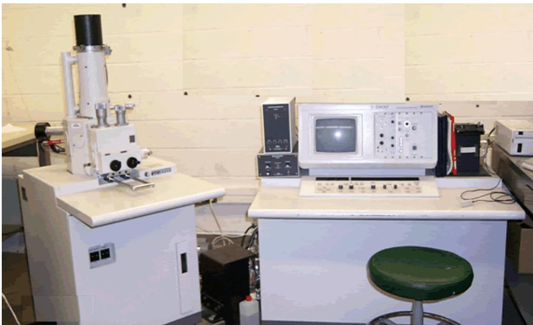
**Figura 2.14.** Microscopio Electrónico de Barrido Marca HITACHI Modelo S-2400.
