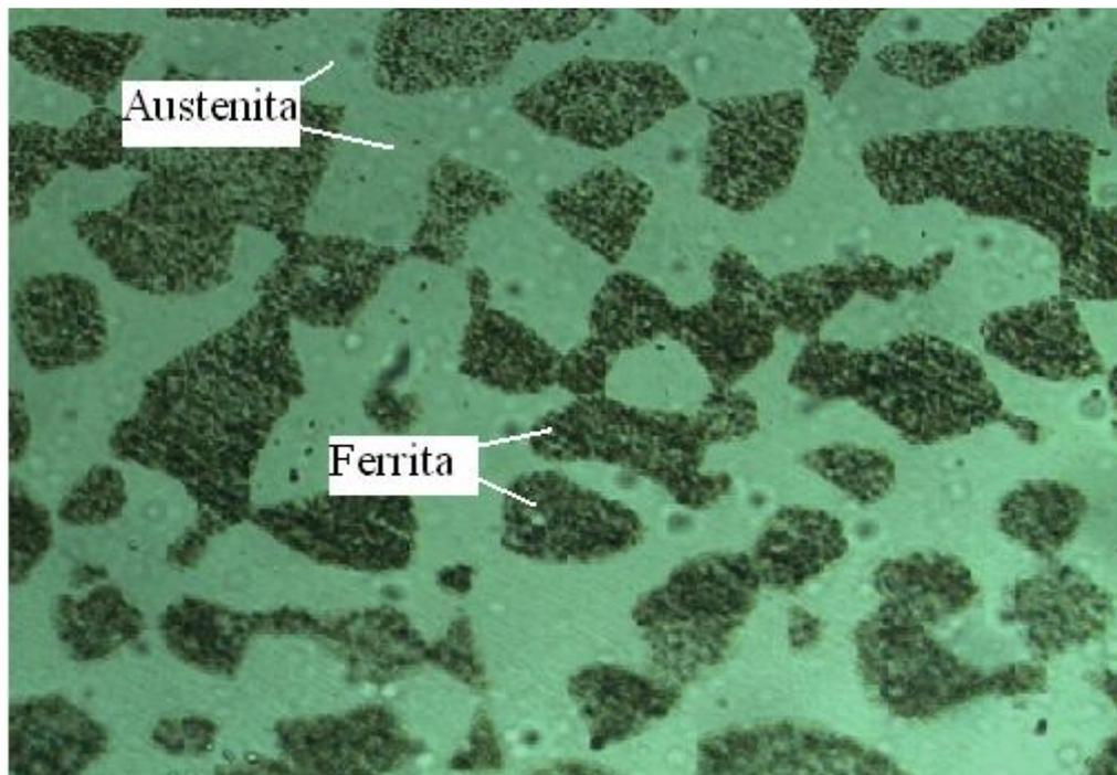
**Figura 3. 4.** Fotomicrografía de la sección transversal del Acero inoxidable SAF 2507.
