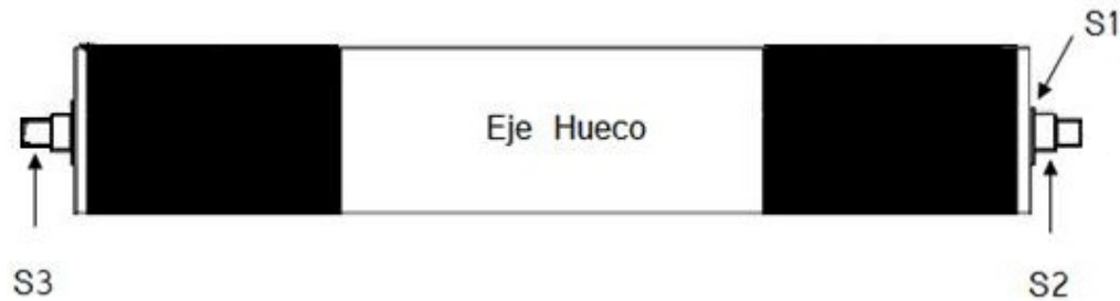
Figura IV-12. Señalamiento de zonas en el rodillo.
