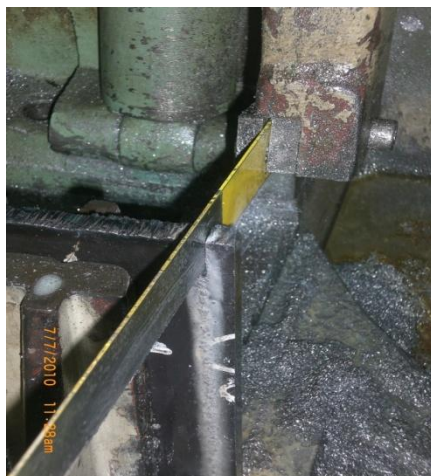
Figura 34. Corte de la plancha
