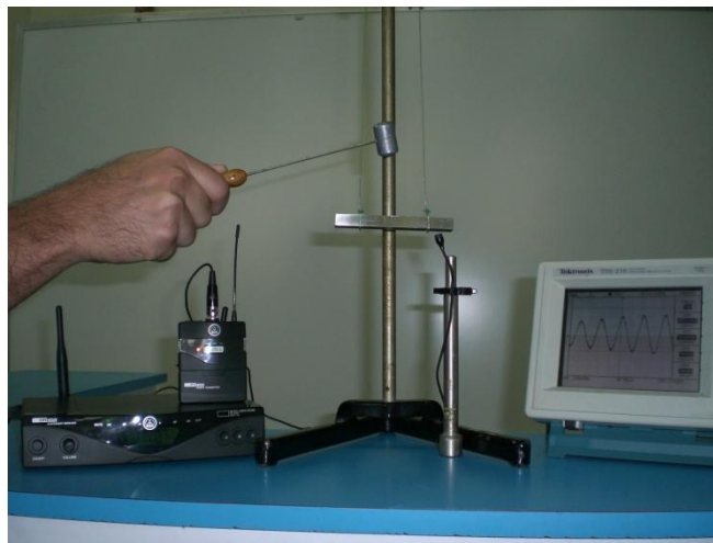
Figura 52. Foto del ensayo de percusión
