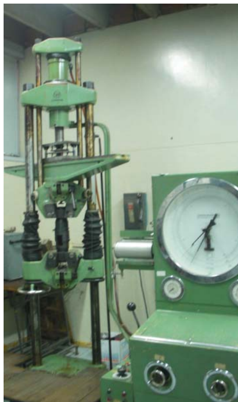
Figura 2.8 Montaje del ensayo de compresión plana en la Máquina Universal de Ensayos Mecánicos
