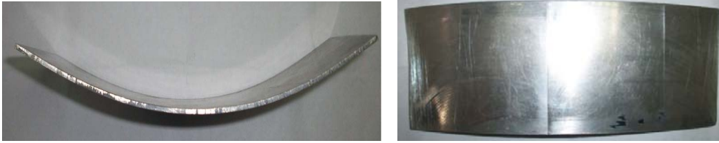
Figura 3.3 Aspecto final de la probeta laminada
