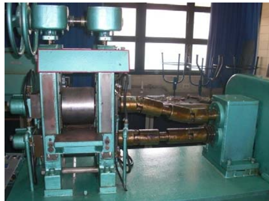
Figura 2.9 Laminadora escala laboratorio, Escuela de Ingeniería Metalúrgica
