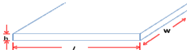
Figura 2.5 Probeta para el ensayo Ford
