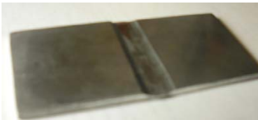
Figura 3.2 b Apariencia final de la probeta 2 del ensayo tipo Ford
