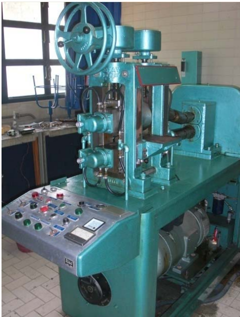
Figura 2.9 Laminadora escala laboratorio, Escuela de Ingeniería Metalúrgica
