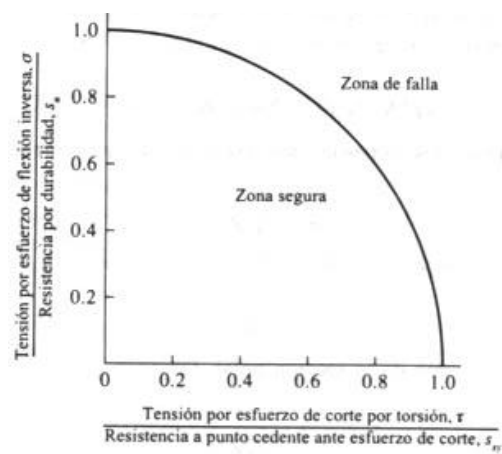
Figura E. Base para la ecuación de diseño de ejes para tensión por esfuerzo de flexión inversa sucesiva y tensión por esfuerzo de corte por torsión
