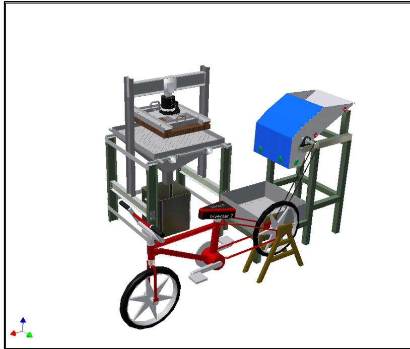
Figura #57. Sistema Rallador accionada manualmente. (Fuente: Los Autores)
