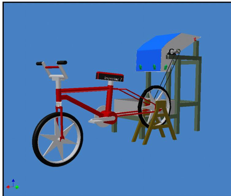
Figura #46. Sistema Rallador con la Bicicleta acoplada. (Fuente: Los Autores)
