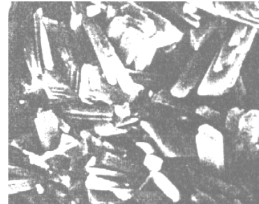
(b) Microporosidad causada por rechazo entre los cristales, 2000 X.
