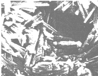
(a) Microporosidad causada por agua remanente, 2000 X.
