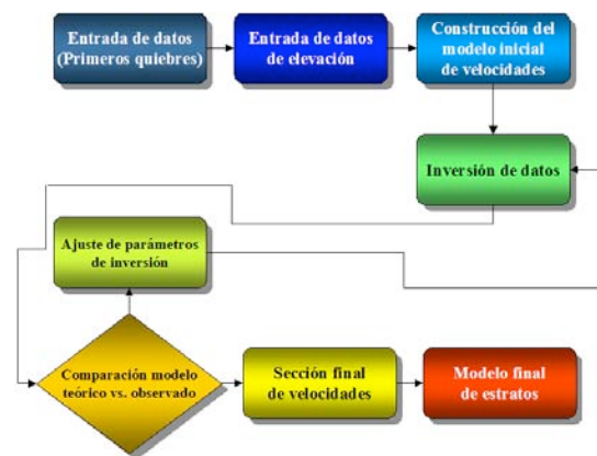
Fig. 4 Secuencia utilizada para procesar los datos sísmicos.
