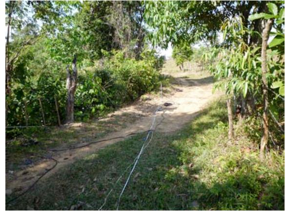
Fig. 3 Disposición sobre el terreno de un sondeo sísmico de refracción. La geometría utilizada es de 3 m de offset y 6 m de intervalo entre geófonos.
