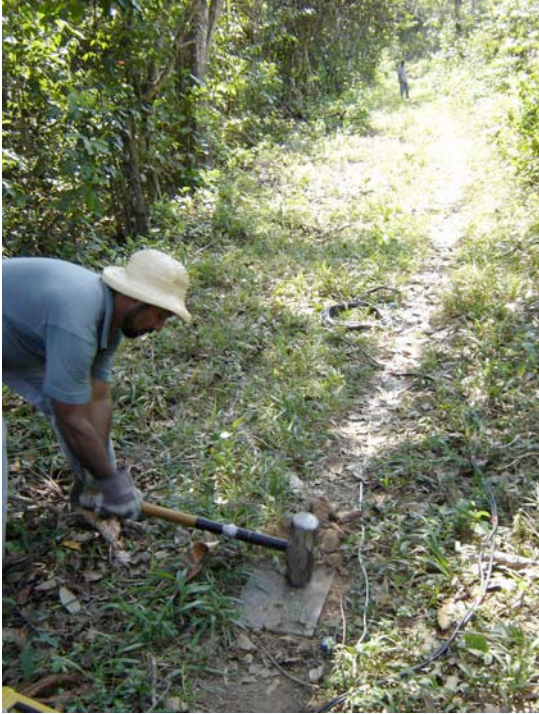
Fig. 2 Generación de ondas sísmicas por impacto mecánico de mandarina sobre placa con sistema repetitivo.
