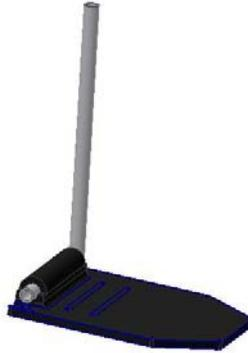
*Figura 5.9. Posapies Ensamblado*
