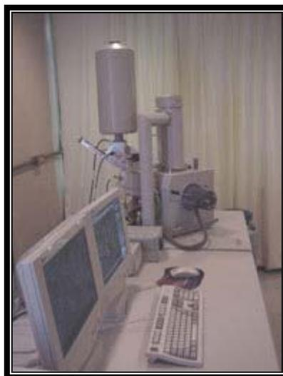
**Figura 3.4.** Microscopio electrónico de barrido Philips modelo XL30.
