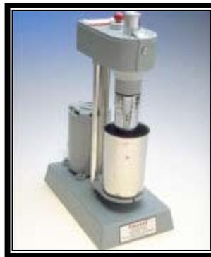
Figura 3.13. Viscosímetro Fann 35<sup>a</sup>.
