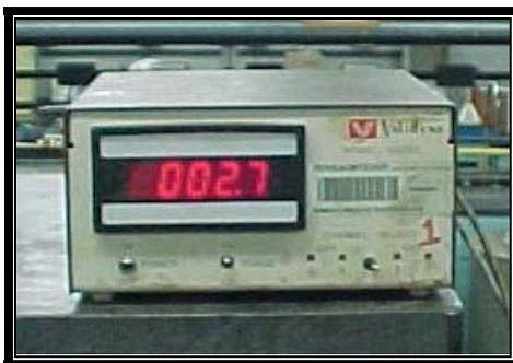
**Figura 10.5.** Medidor de variación de presión Validyne modelo CD223.
