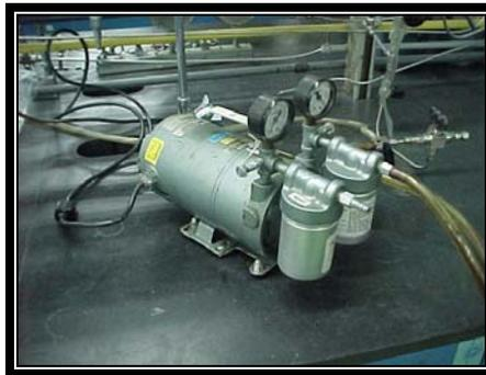
Figura 3.18. Bomba de vacío Cole Parmer.
