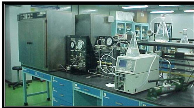
Figura 3.19. Simulador físico de interacción del medio poroso.
