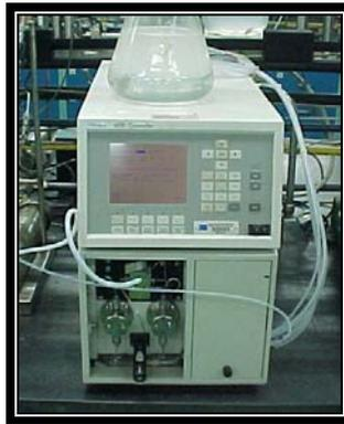
Figura 10.1. Bomba de inyección Waters 600 Controller.
