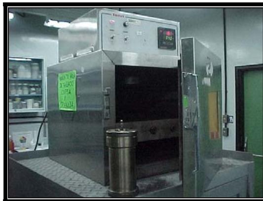
**Figura 3.10.** Horno de envejecimiento rotativo.
