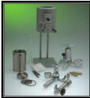
Figura 3.11. Filtro prensa HPHT Fann 175 ml.
