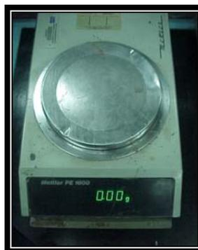
Figura 3.12. Balanza electrónica Mettler PE 1600.
