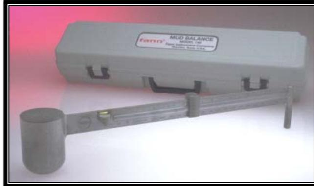
**Figura 3.6.** Balanza para lodo Fann.
