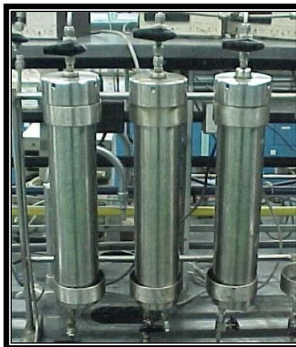
**Figura 10.4.** Celdas de almacenamiento de fluidos.
