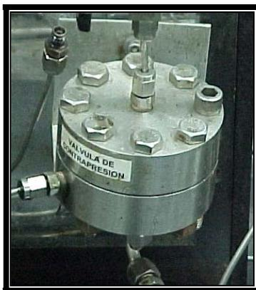
Figura 10.9. Válvula de contrapresión.
