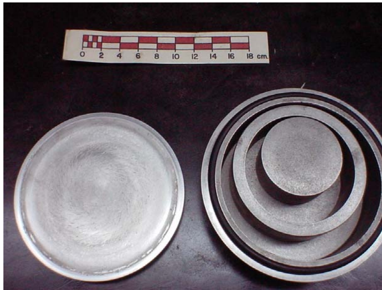
Figura 1.4. Cámara de Tungsteno del Shatterbox.
