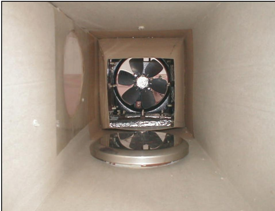
Anexo 23. "Túnel de secado, detalle interno, balanza, ventilador, tobera, resistencias"
