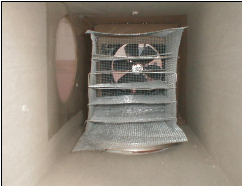
Anexo 29. “Túnel de secado, detalle de cesta para la colocación de las muestras”
