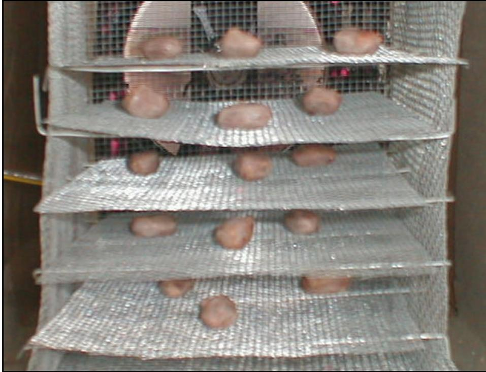
Anexo 30. "Túnel de secado en funcionamiento con muestras de cacao"
