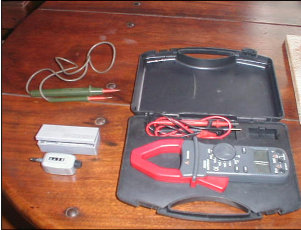
Anexo 28. “Túnel de secado, instrumentos utilizados en la construcción y medición de variables en el túnel, pinza amperimétrica, voltímetro y cuenta revoluciones”
