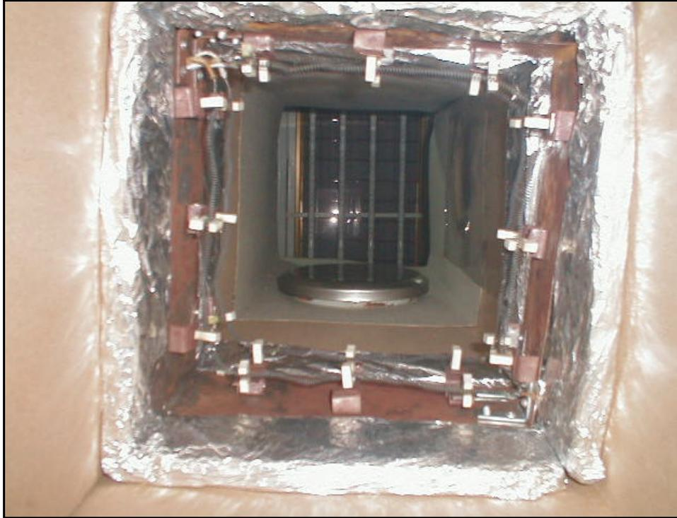
Anexo 24. "Túnel de secado, detalle resistencias"
