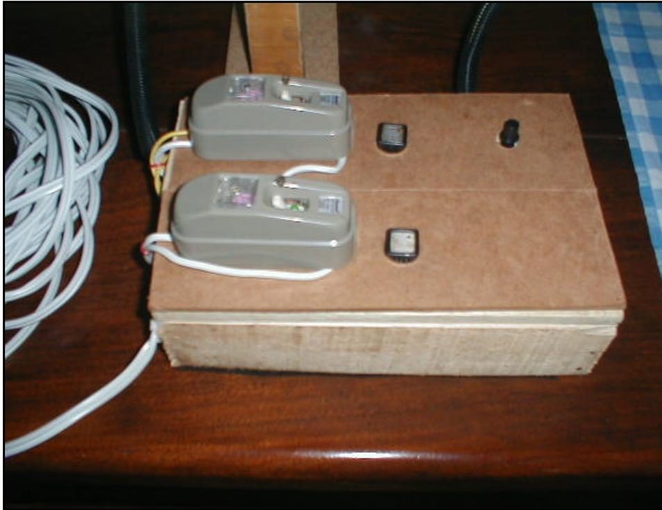
Anexo 26. “Túnel de secado, tablero de control, suiches individuales para las resistencias con sus respectivos potenciómetros y potenciómetro del ventilador”
