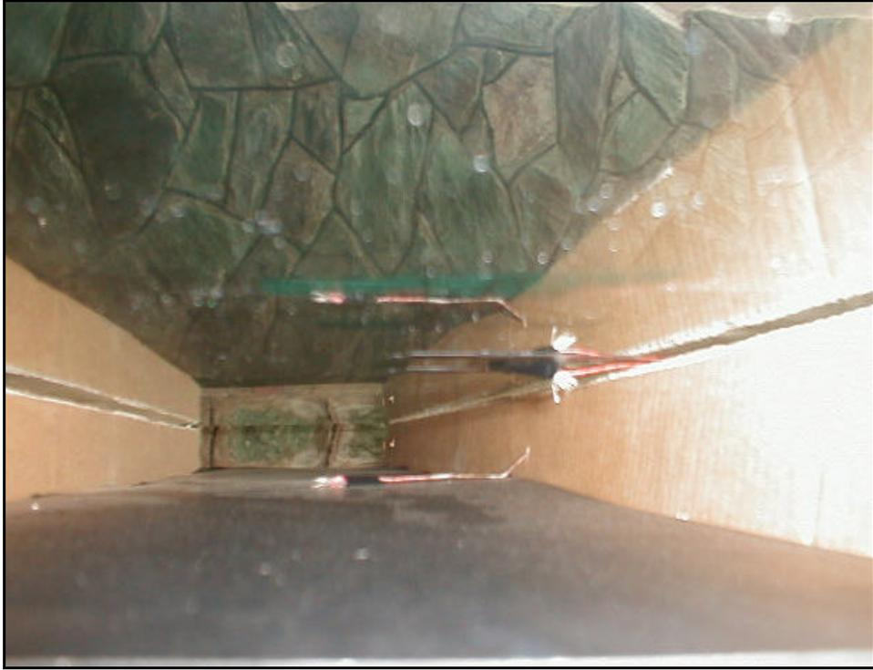
Anexo 34. "Calentador solar plano de aire, vista de sección transversal y detalle de termocuplas"
