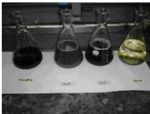
Figura N° 25: Comparación entre los efluentes obtenidos de la precipitación química y el efluente residual de la etapa de curtido.
