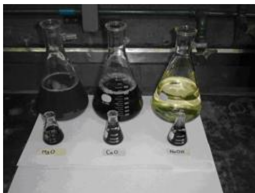
Figura N° 27: Licores de sulfato de cromo obtenidos con cada agente precipitante.
