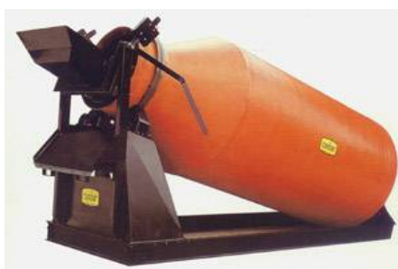
Figura N° 11: Equipo donde se realizan los procesos de ribera y curtido
