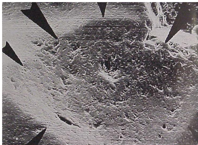
Gráfico 18. Fotomicrografía donde se aprecia el desgaste localizado en una restauración de resina compuesta. Tomado de Leinfelder, 1991.
