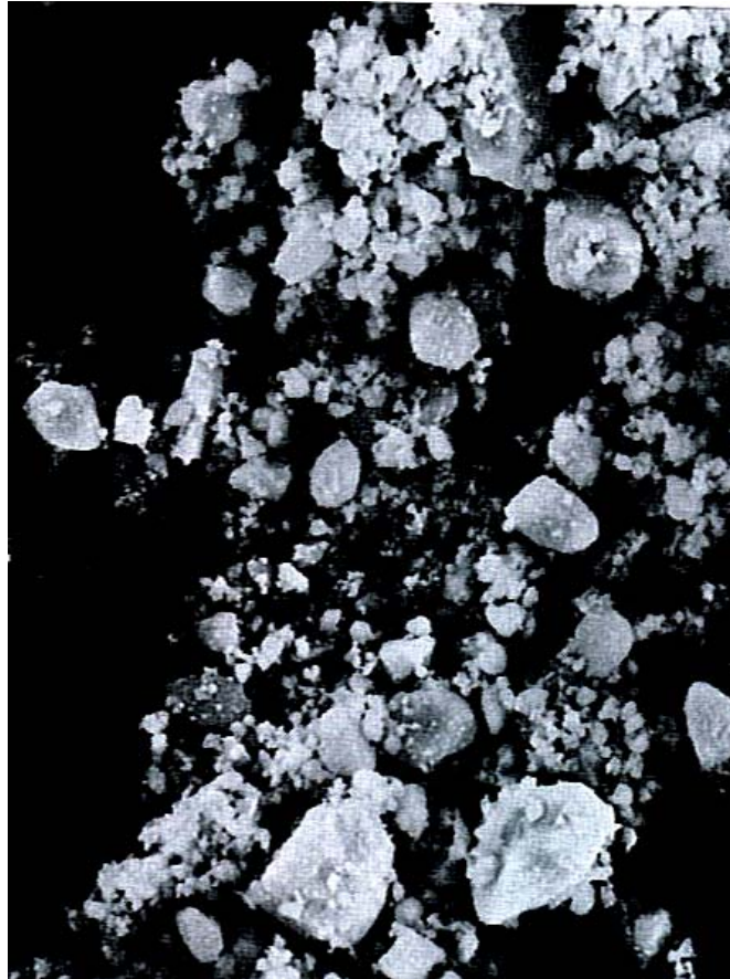
Gráfico 2. Partículas típicas de resinas compuestas de partícula pequeña. Tomado de Anusavice, 2003.
