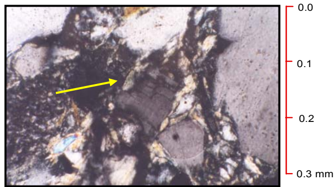
Figura 63. MG-192 (1443-44) Cristales de clorita precipitados en espacios porosos. Nícoles Cruzados. Objetivo 25x
