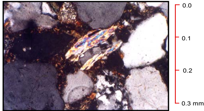
Figura 36. VLC-737 (9221-23) Fragmento de roca Metamórfico tipo esquistó micáceo cuarzo. Nícoles Cruzados. Objetivo 25x
