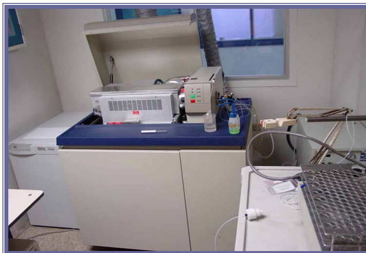
Figura 27. Espectrómetro de masa con ICP empleado en la determinación de los porcentajes de platino y paladio.
