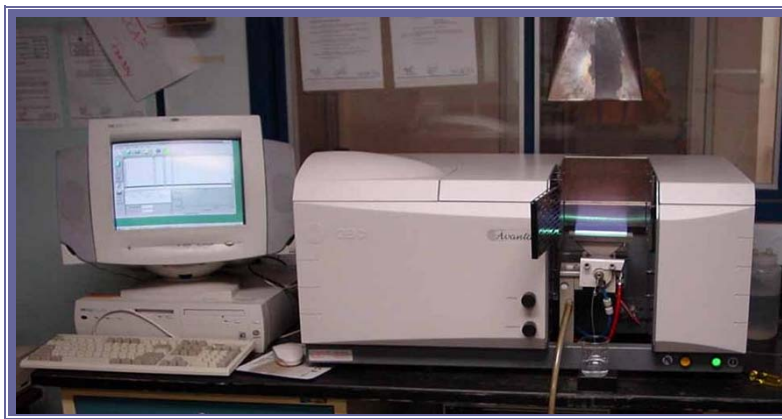
Figura 24. Equipo de absorción atómica empleado en el análisis químico.
