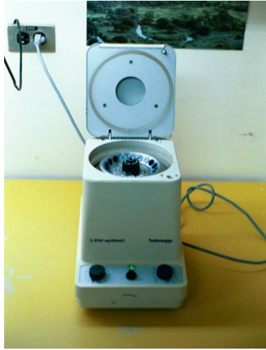
Fig. 2.- Centrífuga utilizada durante la extracción del ADN. Velocidad utilizada: 14000 rpm.
