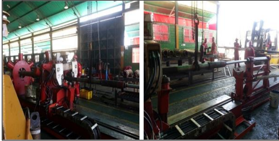
Figura II. 31. Gato hidráulico ejerciendo presión sobre AGS
