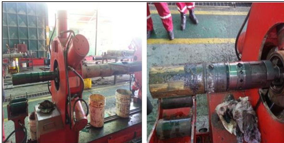
Figura II. 34. Desmontaje del choke housing
