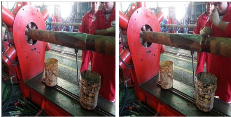
Figura II. 32. Desenrosque de tornillos para liberar cuerpo interno
