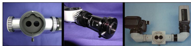
Gráfico 11. Divisor óptico y adaptador Carr
