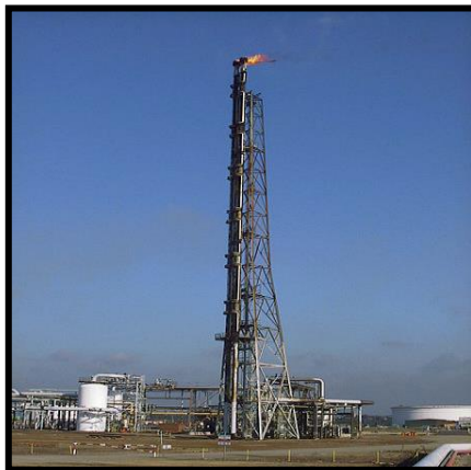
Figura II.10. Mechurrio de Tipo Elevado (Mezcla Azeotrópica, 2012)
