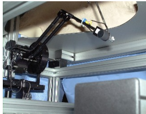
Figura 3-4. Pruebas de retroalimentación sobre abdomen con forma femenina.
