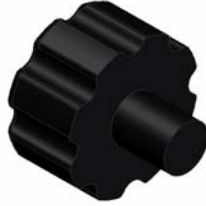
Figura 4-32. Perillas, unión entre extremidades.
