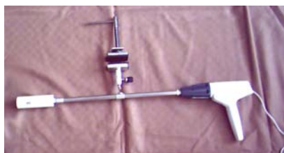
Figura 6-6. Ensamble de Laparoscopio con sostén.
