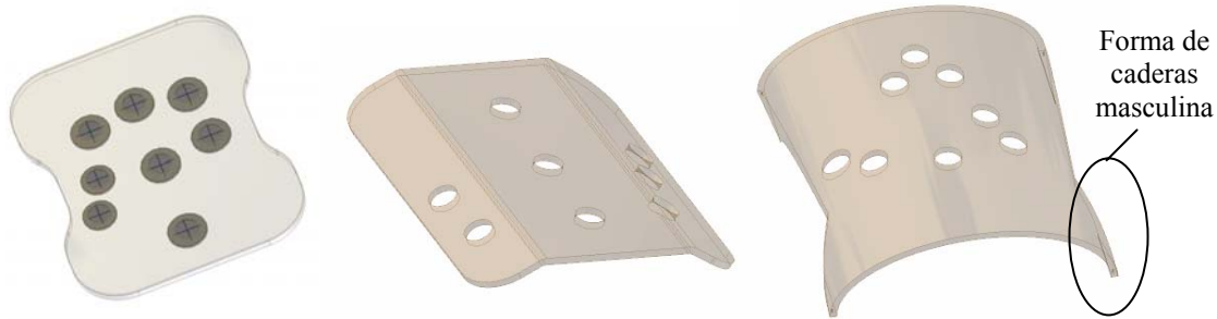
Figura 4-24. Evolución del diseño de superficie de penetración.
