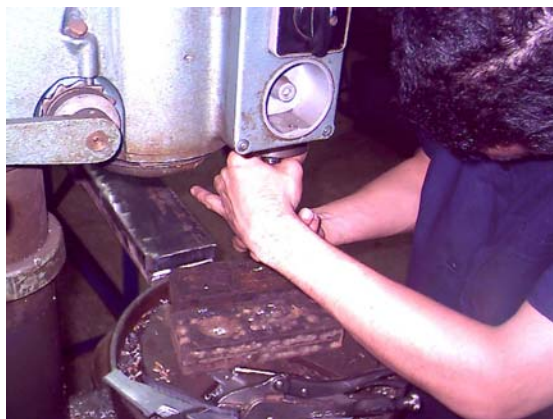
Figura 6-8. Taladrado de soportes de aluminio
