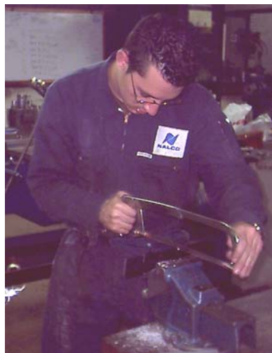
Figura 6-7. Limado y cortes con segueta en láminas de acrílico.
