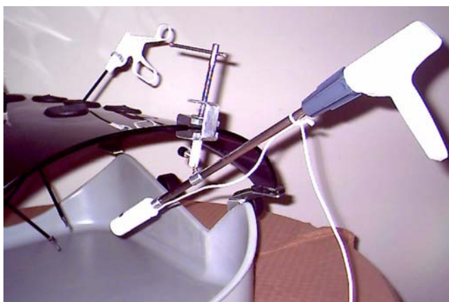
Figura 6-12 Ensamble prototipo, detalle del sujetador de la cámara.
