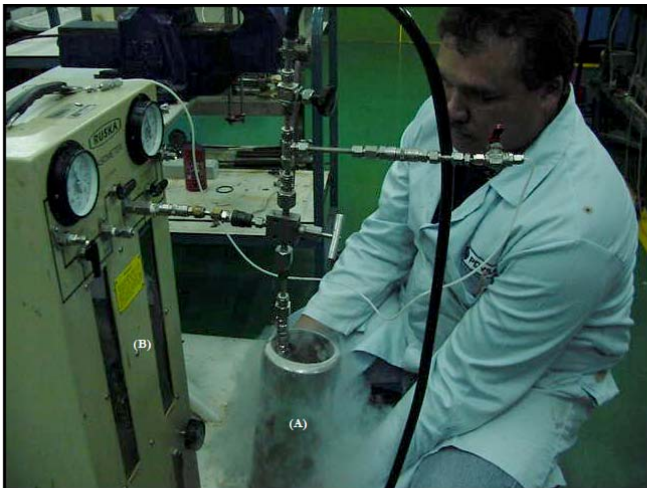
Figura 33. Transferencia del gas del gasómetro al cilindro recolector de gas sumergido en nitrógeno líquido
