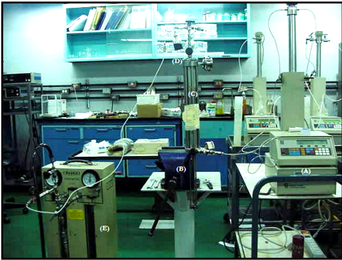
Figura 35. Experimento de liberación flash desde el cilindro colector de muestras de hidrocarburo
