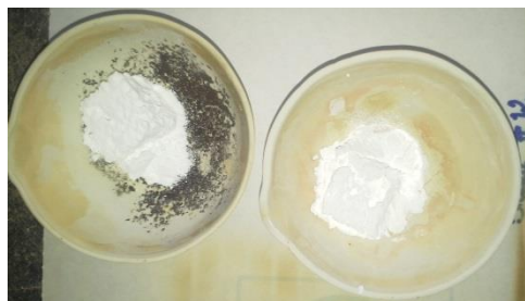
Figura N°27. Esponjas cerámicas N°10 luego de calcinación a 700°C.
