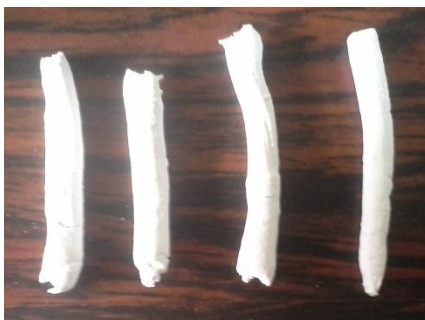
Figura N°54. Extruídos luego de calcinación a 700°C.
