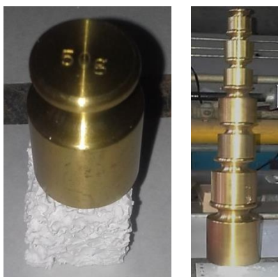
Figura N°28. Procedimiento utilizado para evaluar la resistencia mecánica de las estructuras cerámicas.
