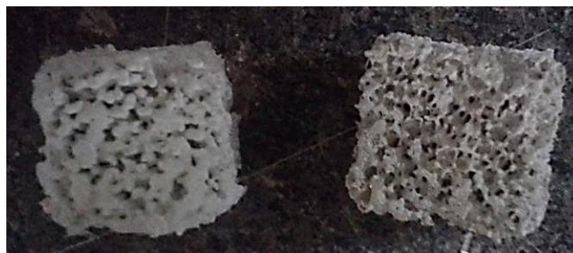
Figura N°41. Monolito recubierto con zeolita antes y después del baño de ultrasonido.
