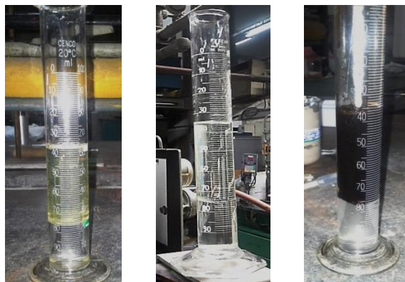
Figura N°57. Sistema de moldeado en aceite. 57a) Aceite para máquina de coser. 57b) Aceite para bebé. 57c) Aceite de motor.
