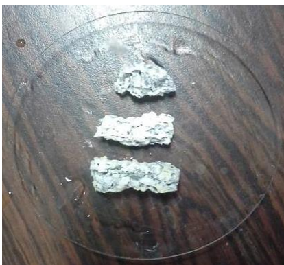
Figura N°49. Soportes metálicos recubiertos con slurry zeolita N°1 luego de calcinación a 450°C.
