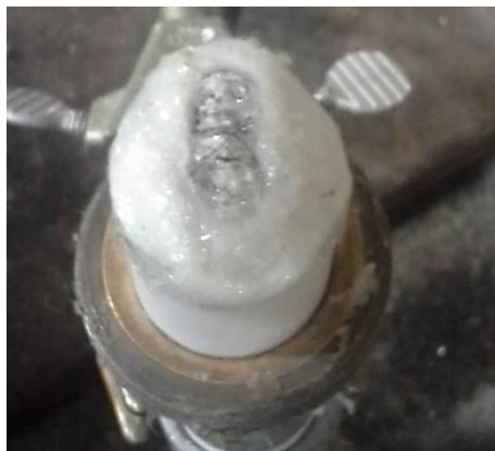
Figura N°52. Estructura metálica sellada para realizar medidas de caídas de presión.
