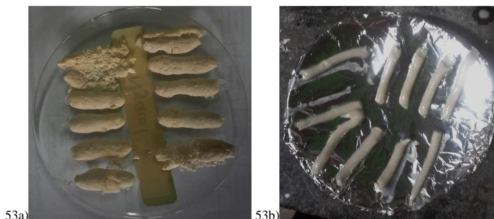
Figura N°53. Extruídos luego de secado durante 24 horas. 53a) Pasta que contenía alúmina. 53 b) Pasta que contenía caolín.
