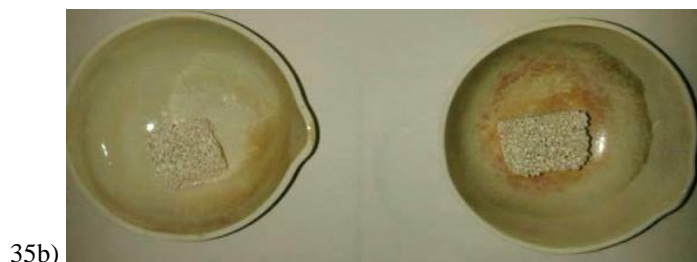
Figura N°35. Monolitos cerámicos obtenidos por el método de recubrimiento spraycoating aplicado 2 y 3 veces, luego de calcinación a 900°C. 37a) Slurry N°14. 37b) Slurry N°18.
