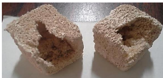
Figura N°44. Monolitos recubiertos con slurry cerámico luego de la calcinación a 900°C, para esponjas de tamaño de poro pequeño.
