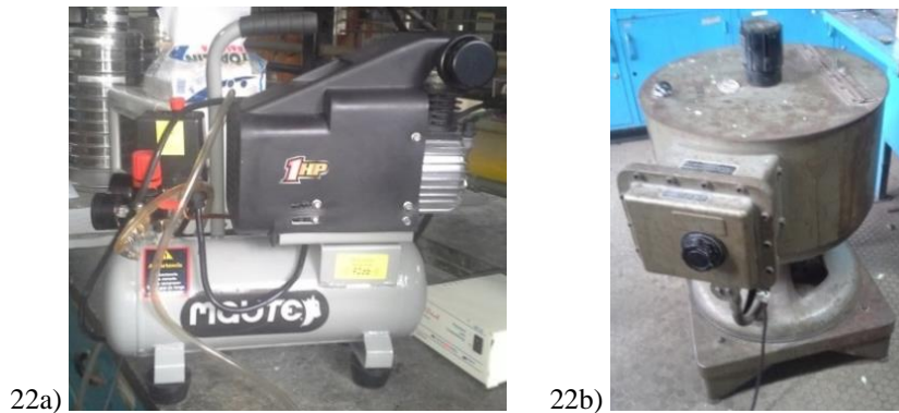
Figura N°22. 22a) Compresor utilizado para el proceso de impregnación. 22b) Centrífuga utilizada para el proceso de impregnación.
