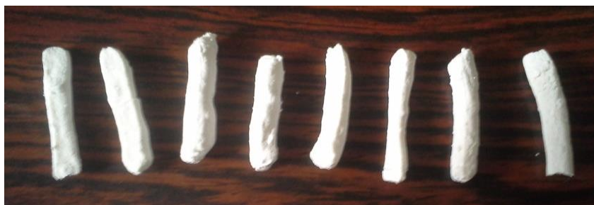
Figura N°55. Extruídos luego de calcinación a 900°C.
