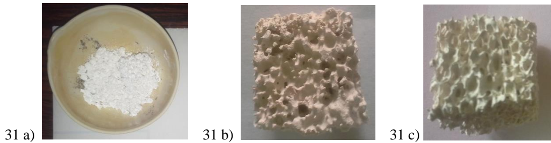
Figura N°31. Estructuras luego de calcinación a 1100°C. 34a) Slurry N°12. 34b) Slurry N°14. 34c) Slurry N°18.
