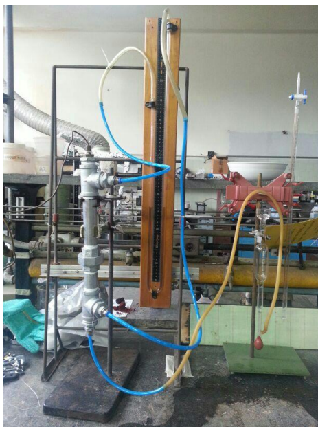
Figura N°14. Sistema instalado en el Laboratorio de Refinación y Petroquímica para medidas de caída de presión.
