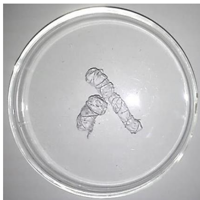
Figura N°50. Estructuras metálicas recubiertas con slurry zeolita N°2 luego de calcinación a 550°C.
