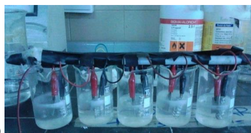
Figura N°43. 46a) Fuente de poder utilizada. 46b) Proceso electroquímico de anodizado.
