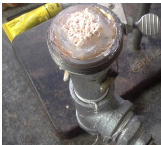
Figura N°42. Estructura cerámica sellada para realizar medidas de caída de presión.
