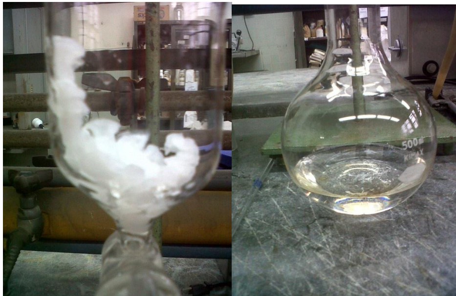
Figura Nº 15: Materia vegetal luego de la extracción Soxhlet y extracto de Aloe Vera
