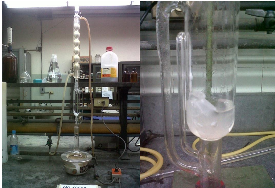
Figura Nº 14: Montaje de la Extracción Soxhlet y materia vegetal durante la extracción
