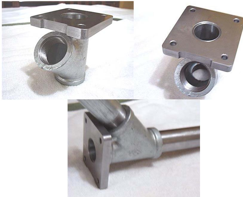
Figura 16. Base del barril ensamblada
