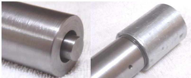
Figura 13. Izquierda: detalle de la salida del molde. Derecha Molde acoplado al anillo
