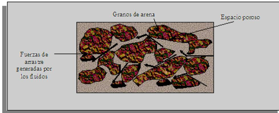
**Figura N° 4.1. Movimiento de los granos de arena causados por esfuerzos desestabilizadores.**
