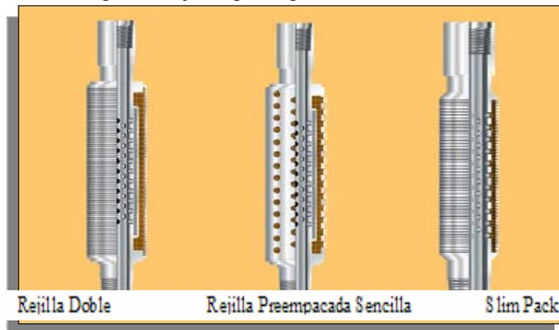
Figura N° 4.4 Tipos de Rejillas Preempacadas
