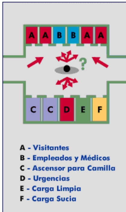
Figura 17. Mala disposición de ascensores de distintos usos. [OTIS, 1998]
