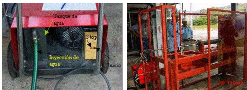
Fig. 4.2.3: Herramienta usada para el ensayo de Penetración del Lecho de Coque
