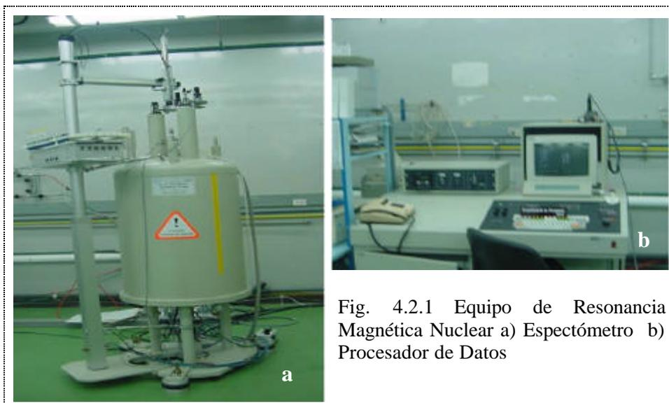
Fig. 4.2.1 Equipo de Resonancia Magnética Nuclear a) Espectrómetro b) Procesador de Datos
