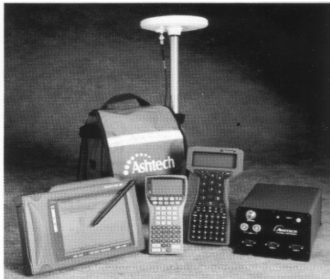
Ilustración 10: Aparecen el GPS diferencial de la marca Reliance; el ordenador PenMap con el programa Reliance de campo; los colectores Workabout y Husky; y el sensor Z-1 2. Detrás aparece la mochila del Reliance con el Receptor SCA-12 y la antena de campo.
