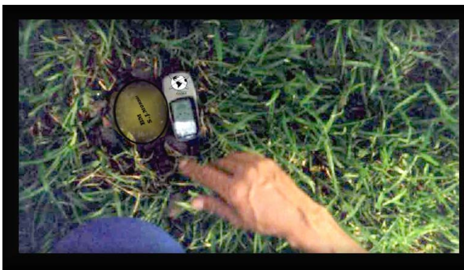
Figura N° 33: Equipo de posicionamiento satelital global, GPS navegador GARMIN eTrex y BM: Red Gravimétrica Nacional. Estación Plaza Bolívar de San Juan de Los Morros, Edo. Guárico.
