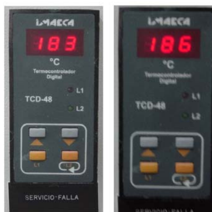
Figura 4.3.1 Calibración de los límites del control de temperatura. (Los autores)
