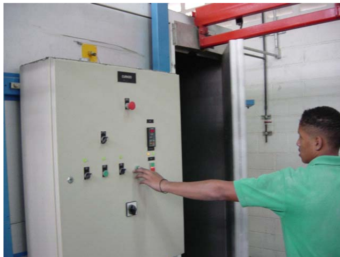
Figura 5.2.1 Pulsador para el cierre de la puerta de la entrada (Los autores)
