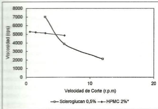
Figura 2. Reogramas de la dispersión de Scleroglucan al 0,5% y de HPMC al 2% a 26 °C. \*Tomado de: Andueza I, Ávila G, Attias D. 2004. «Influencia de la esterilización sobre el comportamiento reológico y pH de una dispersión isotónica de hidroxipropilmetilcelulosa». *Rev Soc Quím Méx* 48: 220-224.
