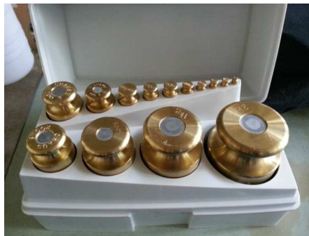
Figura 6: Diferentes pesos para las pruebas de resistencia mecánica
