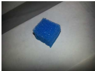
Figura 4: Esponjas de poliuretano con mejor resistencia mecánica
