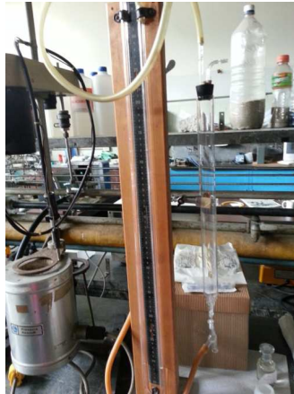
Figura 7: Sistema utilizado para la medición de caída de presión
