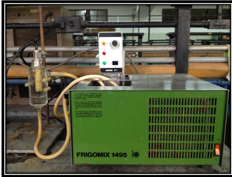
Figura 4. 2: equipo utilizado para disminuir la temperatura.
