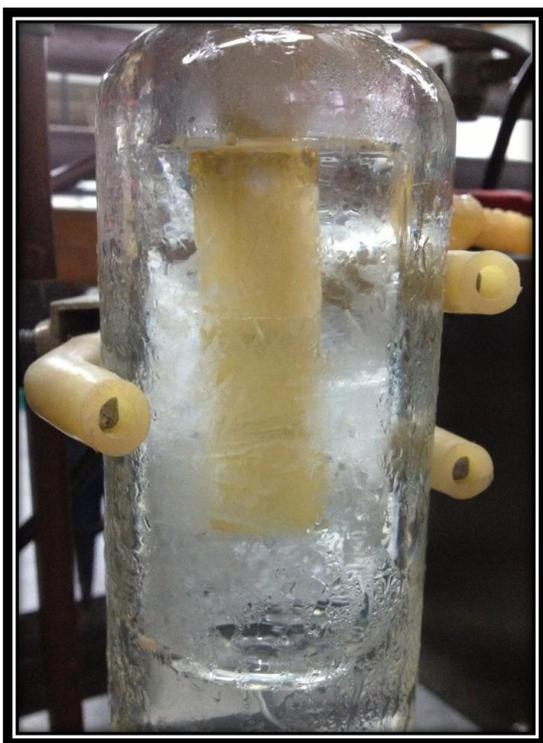
Figura 4. 7: Vaso precipitado con chaqueta en el momento que comienza la nucleación.
