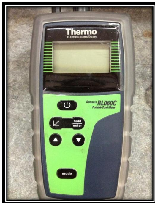
Figura 4. 5: Conductímetro. Medidor de conductividad eléctrica y temperatura.
