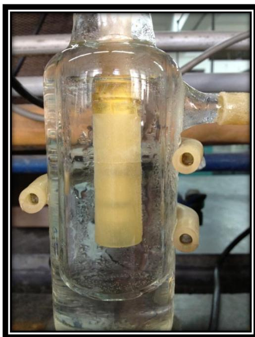
Figura 4. 4: Vaso precipitado con camisa con el conductímetro.
