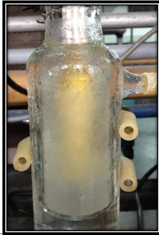
Figura 4. 9: Vaso precipitado con chaqueta en el momento de la cristalización.
