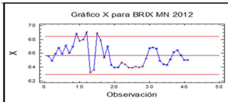
**Figura 30.- Carta de Control de las Mediciones Individuales para los Grados ° Brix del Concentrado de Naranja del Proveedor MN-2012**
