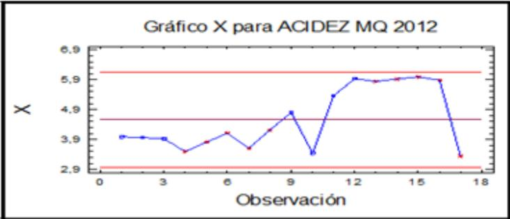
Figura 41.- Carta de Control de las Mediciones Individuales para la Acidez del Concentrado de Naranja del Proveedor MQ-2012.
