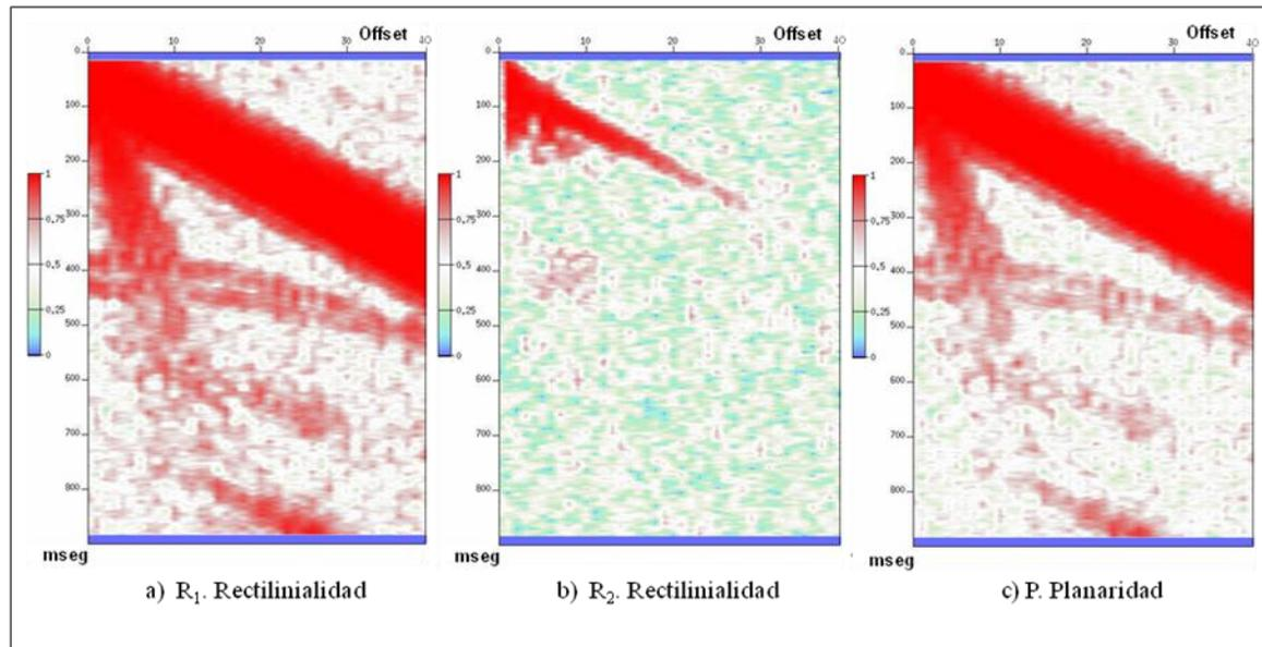
Figura 2. (mseg Vs. Offset) Diagrama de energías: Factores de Rectilinealidad  $R_1$  y  $R_2$  ; Factor de Planaridad  $P$ .
