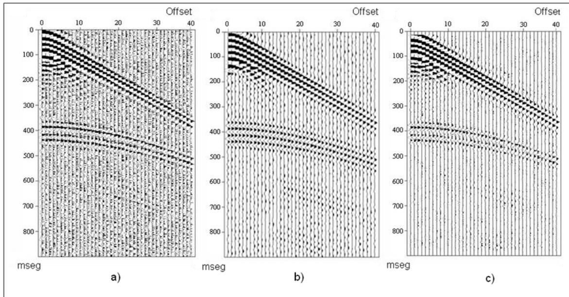
Figura 1. (mseg Vs. Offset). Componente Vertical “Z” de los Registros Sísmicos Sintéticos: a) Registro sin filtrar con ruido aleatorio en la banda de frecuencia de 20Hz a 80Hz b) Registro filtrado a través de un filtro Pasa-Banda (PB) en un rango de frecuencias de 12-16Hz a 40-60Hz y c) Registro utilizando el filtro de Descomposición del Valor Singular (SVD).
