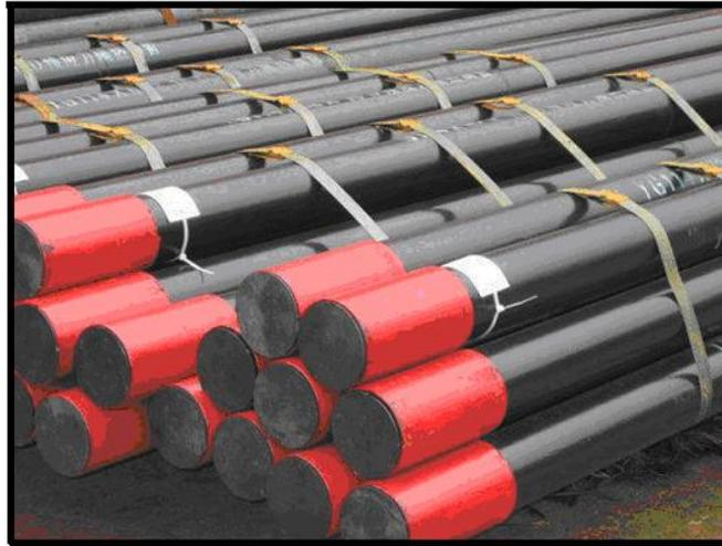
Figura 2.5. Tuberías de producción
