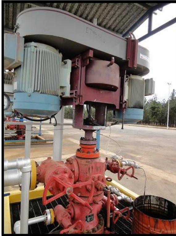
Figura 2.4. Motor y cabezal giratorio.
