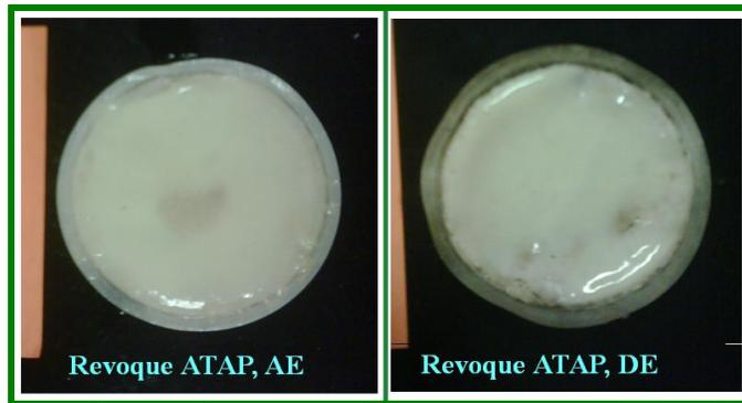
**Figura 5.26:** Revoques obtenido del ensayo Filtrado ATAP del fluido seleccionado antes y después de envejecer [Fotografías tomadas por Pérez, 2011]
