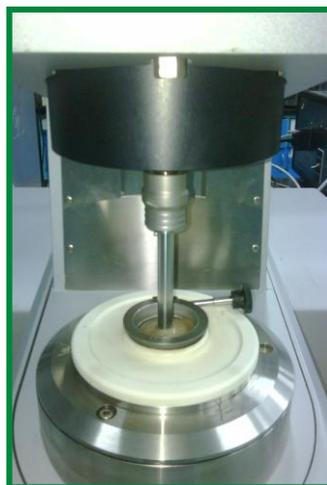
Cilindro y la pieza punteada conectados al equipo [Fotografía tomada por Pérez, 2011]
