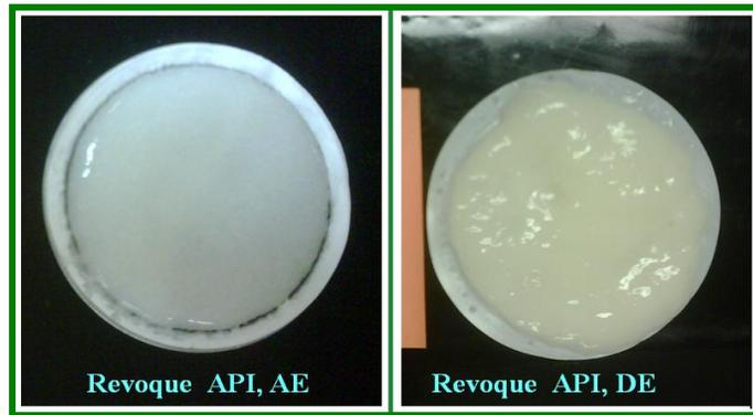
**Figura 5.25:** Revoques obtenido del ensayo Filtrado API del fluido seleccionado antes y después de envejecer [Fotografías tomadas por Pérez, 2011]
