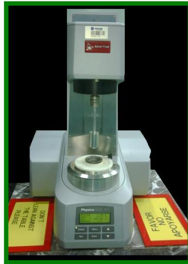
Figura 2.12: Reómetro Dinámico [Fotografía tomada y editada por Pérez, 2011]
