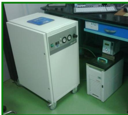
De derecha a izquierda, Baño y Compresor del Reómetro Dinámico[Fotografía tomada por Pérez, 2011]
