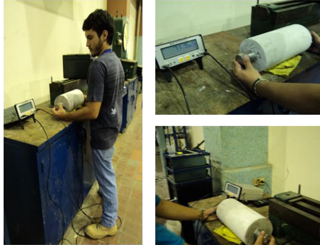
Figura 22. Toma de pulso ultrasónico en probetas cilíndricas de 25x30.
