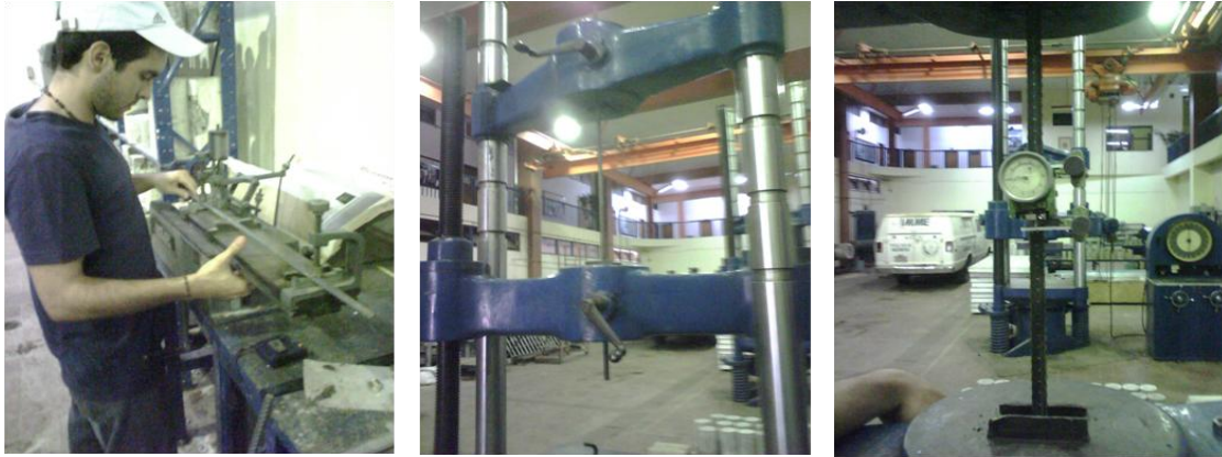
Figura 27. Marcado de la barra de acero SV4S60, colocación de la barra en la máquina universal de ensayo y disposición del extensómetro – Ensayo de Tracción
