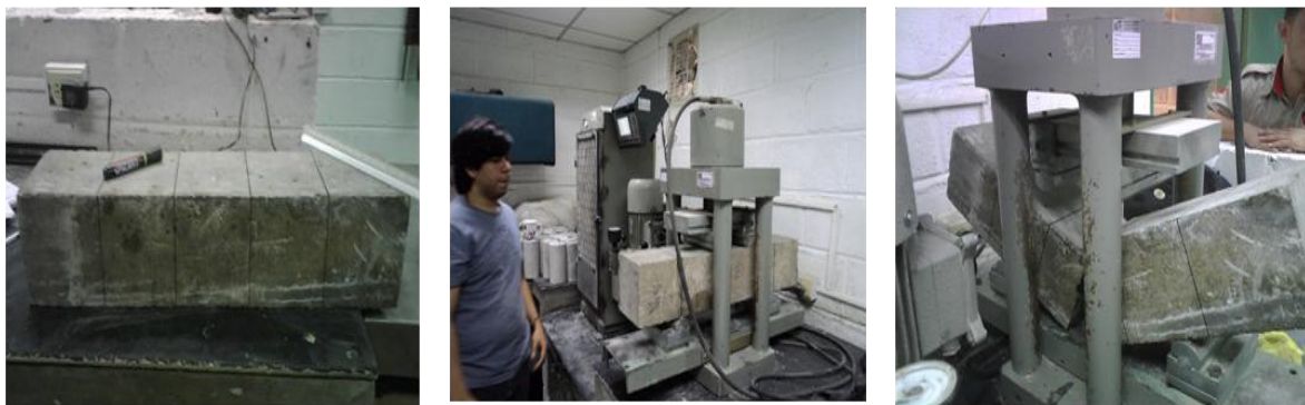
Figura 21. Marcación, colocación y ejecución de ensayo de probetas prismáticas de 15x15x75.
