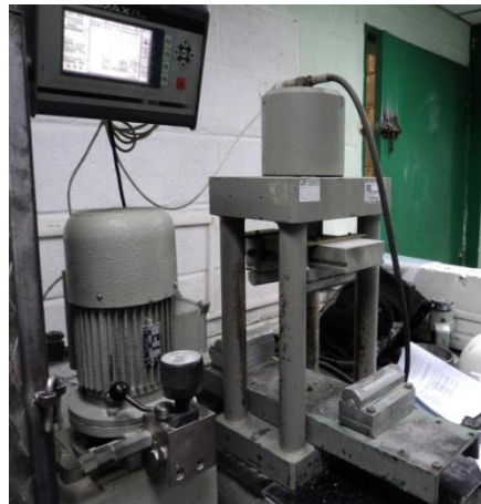
Figura 19. Máquina para ejecución de ensayo de modulo de rotura.
