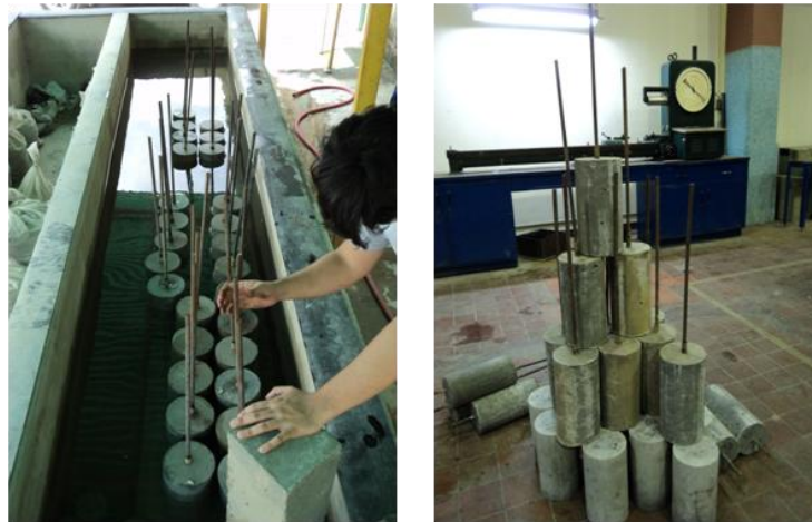
Figura 31. Curado de probetas para ensayo de adherencia
