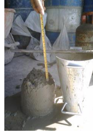
Figura 11. Medición del Asentamiento.
