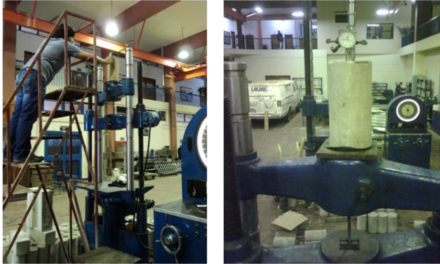
Figura 32. Colocación de probeta en la maquina universal de ensayo
