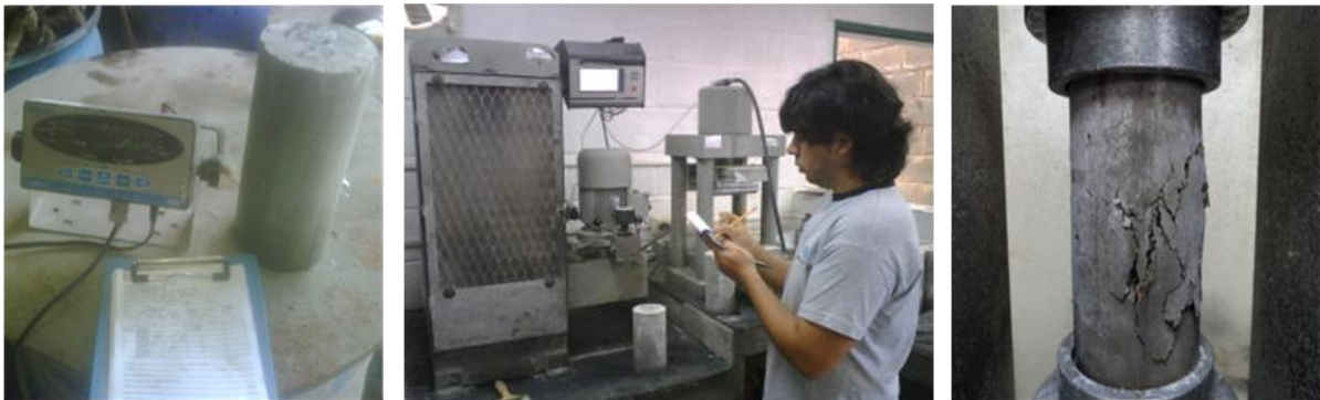
Figura 16. Ensayo de Compresión de cilindros de 10x20 cm. Fuente: Elaboración propia
