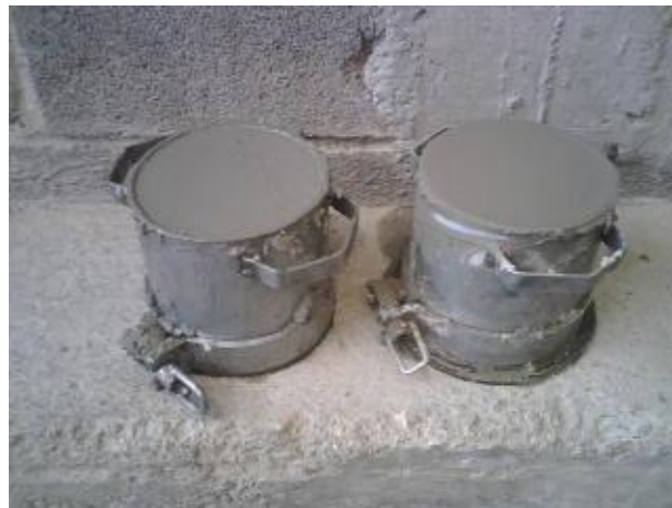
Figura 23. Ensayo de Tiempo de Fraguado.
