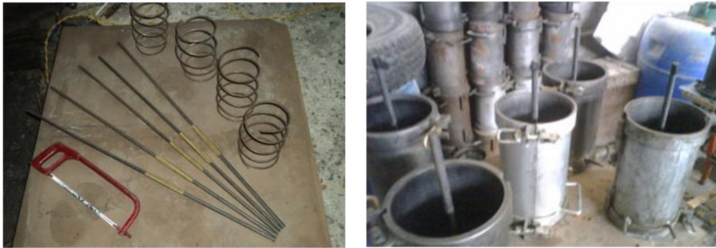
Figura 29. Barras de 1/2", Refuerzos helicoidal y disposición de encofrados antes del vaciado
