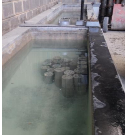
Figura 14. Probetas cilíndricas sumergidas en la piscina de curado.
