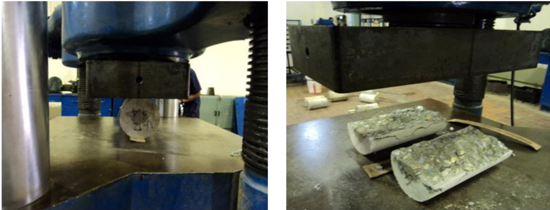
Figura 18. Colocación inicial de probeta y Falla tipo de ensayo de tracción indirecta.
