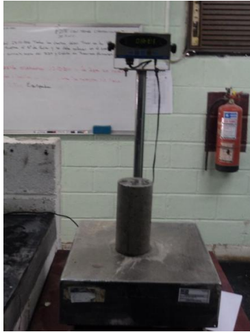
Figura 15. Toma del peso de probetas cilíndricas en balanza.
