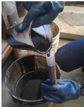
Figura 9. Medición en cilindro graduado del lubricante residual
