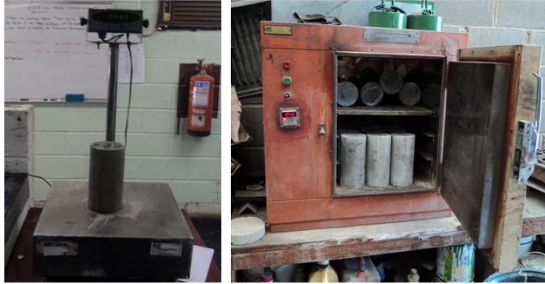
Figura 24. Toma de peso y colocación de probetas cilíndricas en el horno.
