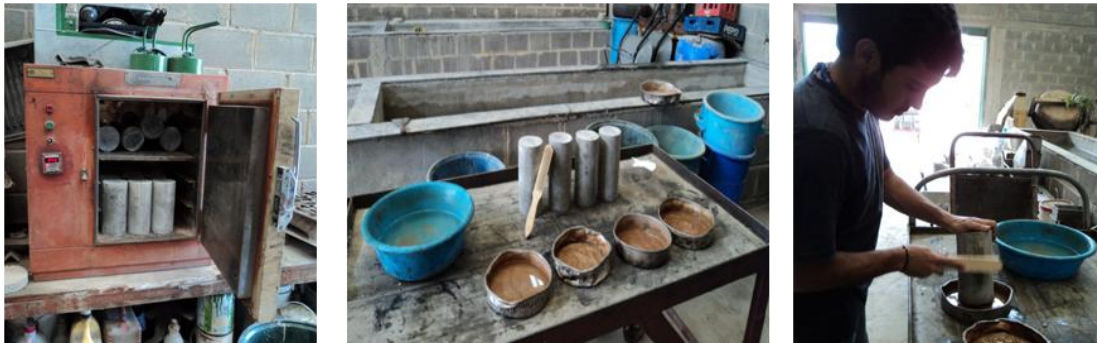
Figura 25. Secado al horno y cepillado de probetas para ensayos de erosión.
