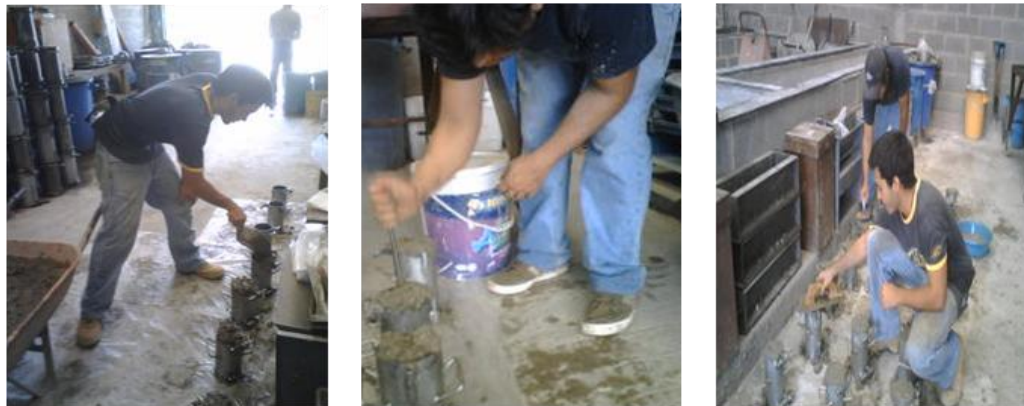
Figura 13. Colocación, Compactación y Enrasado de las probetas.
