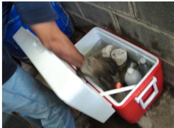
Figura 26. Colocación de Probetas en cava para ensayo de cambios brusco de temperaturas
