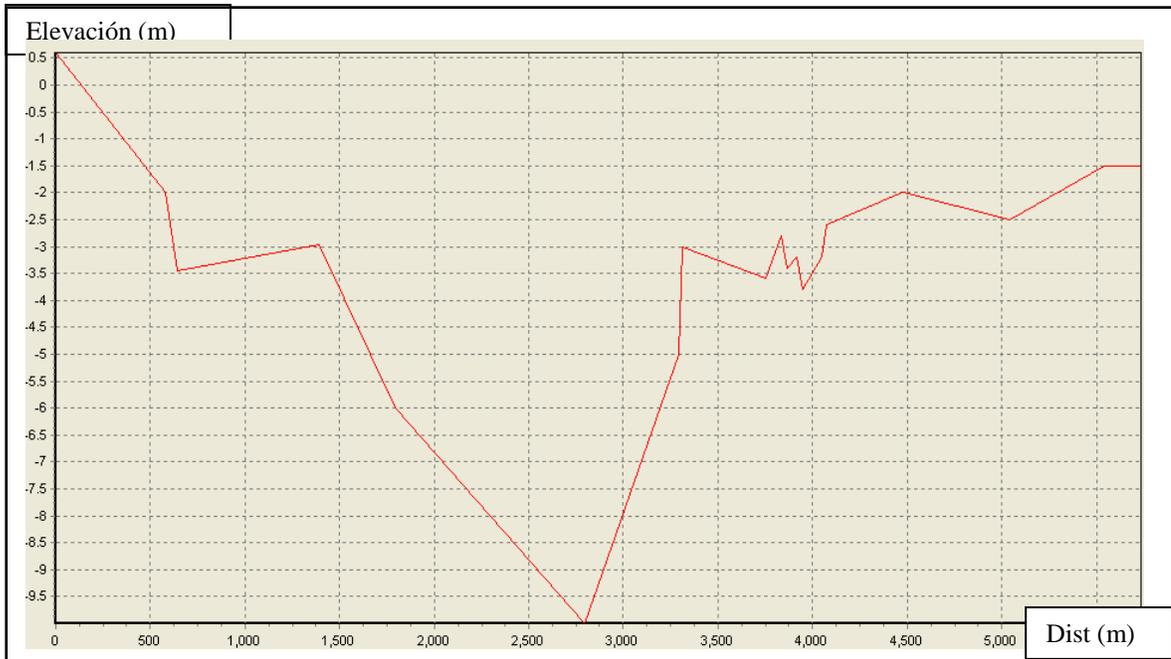
Figura 4.1.3. Perfil topográfico del tramo 1  $\Phi$  (30 pulgada) de la red de la E.F O-16
