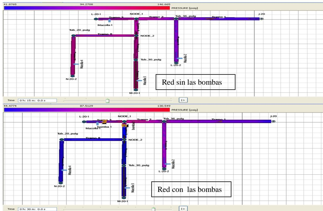
Figura 4.4.9. Caídas de Presiones en la red de transporte de la E.F. J-20
