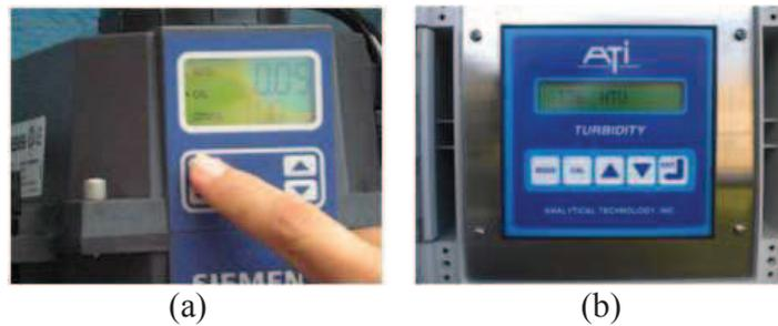
Figura 49. Paneles de turbidímetros energizados. (a) Panel del turbidímetro de agua precipitada. (b) Panel del turbidímetro de agua cruda.
