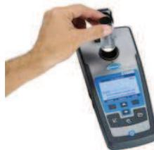
Figura 3. Turbidímetro de laboratorio.
