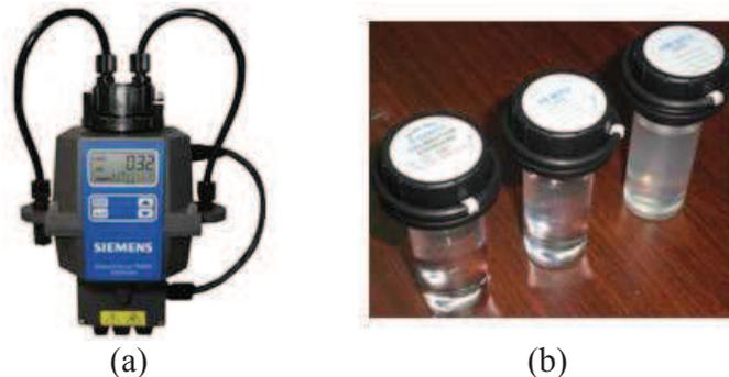
Figura 18. Turbidímetro seleccionado para agua precipitada. (a) Panel del instrumento. (b) Muestras de calibración.
