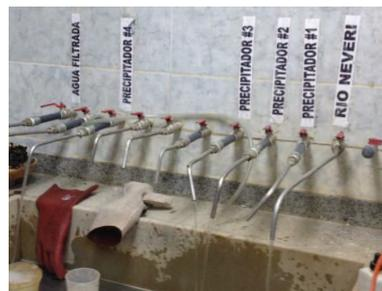
Figura 11. Tuberías para toma de muestras de agua.
