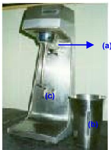
**FIGURA 19. Agitador de alta revolución MONOMIXER**
