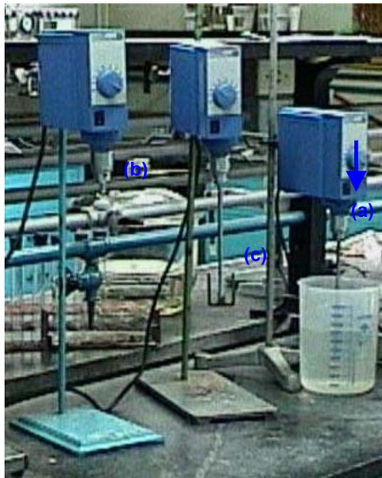
**FIGURA 20. Agitador de baja revolución**
